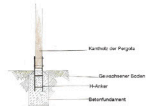
Die Pfosten der Pergola werden durch H-Anker im Boden befestigt.
