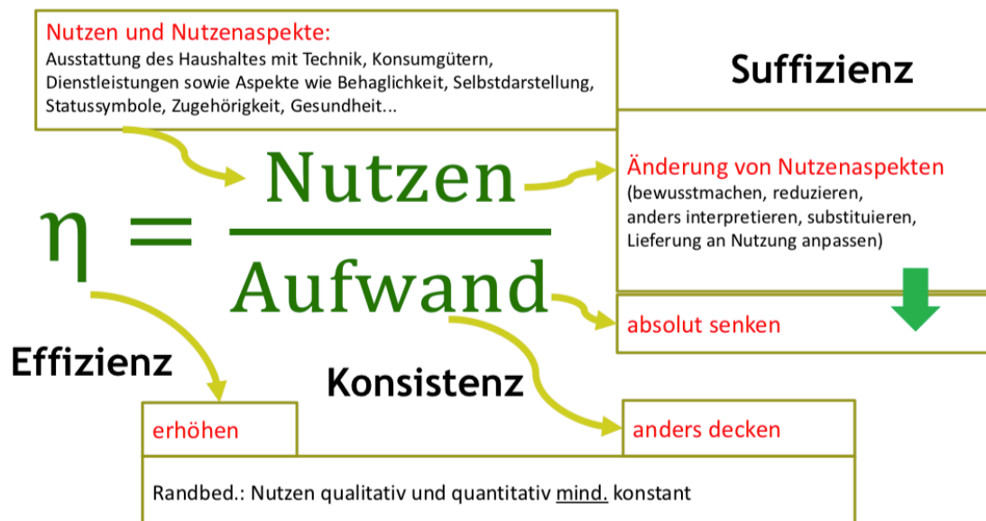
Abbildung 2-2 Unterschiede zwischen Effizienz, Konsistenz und Suffizienz, (Brischke, 2015)
