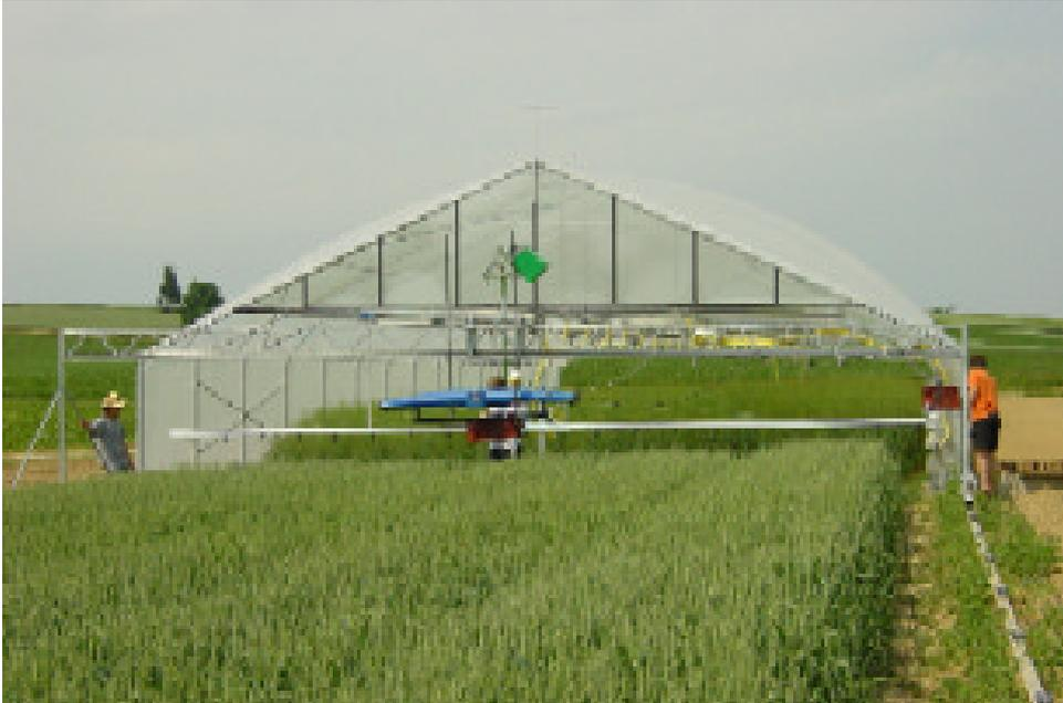
Abbildung 3.1.2: Rain-shelter Anlage mit automatischer Bewässerung und kontinuierlicher Erfassung des Bodenwassergehalts. Auf einem mobilen Trägersystem können verschiedene spektrale Sensoren angebracht werden
