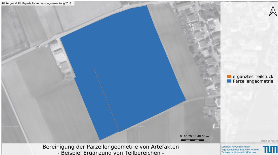
Abbildung 33: Beispiel für die Verfüllung einer als Artefakt betrachteten Einkerbung eines Polygons; die Einkerbung besitzt eine maximale Breite von weniger als 4 cm und eine Länge von mehr als 150 m
