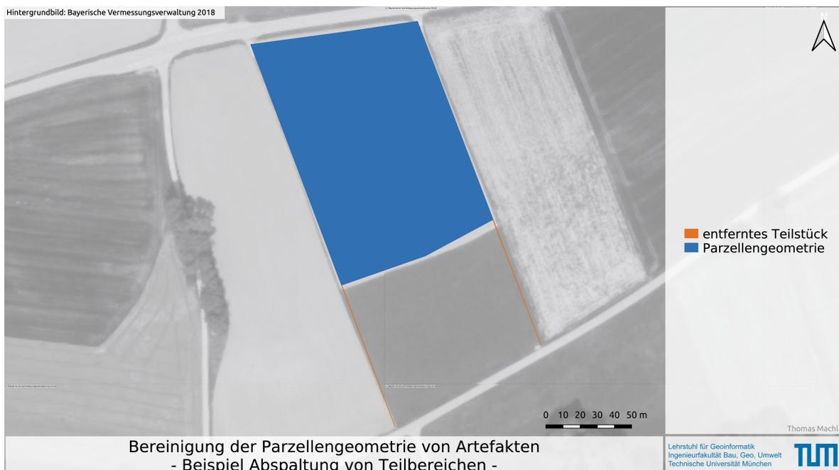
Abbildung 34: Beispiel für die Abspaltung von als Artefakt betrachteten Polygonfortsätzen; die Fortsätze besitzen eine maximale Breite von weniger als 15 cm und eine Länge von rund 90 m (links) bzw. eine maximale Breite von weniger als 25 cm und eine Länge von mehr als 80 m (rechts)
