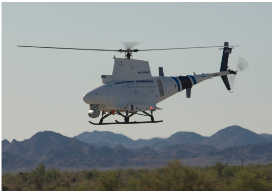
c) MQ-8B Fire Scout (Foto: © Northrop Grumman) Erstflug: 2006, MTOM \approx 1429 kg
