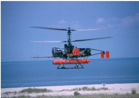
a) Gyrodyne QH-50D (Foto: 5 ) Erstflug: 1960, MTOM \approx 1157 kg
