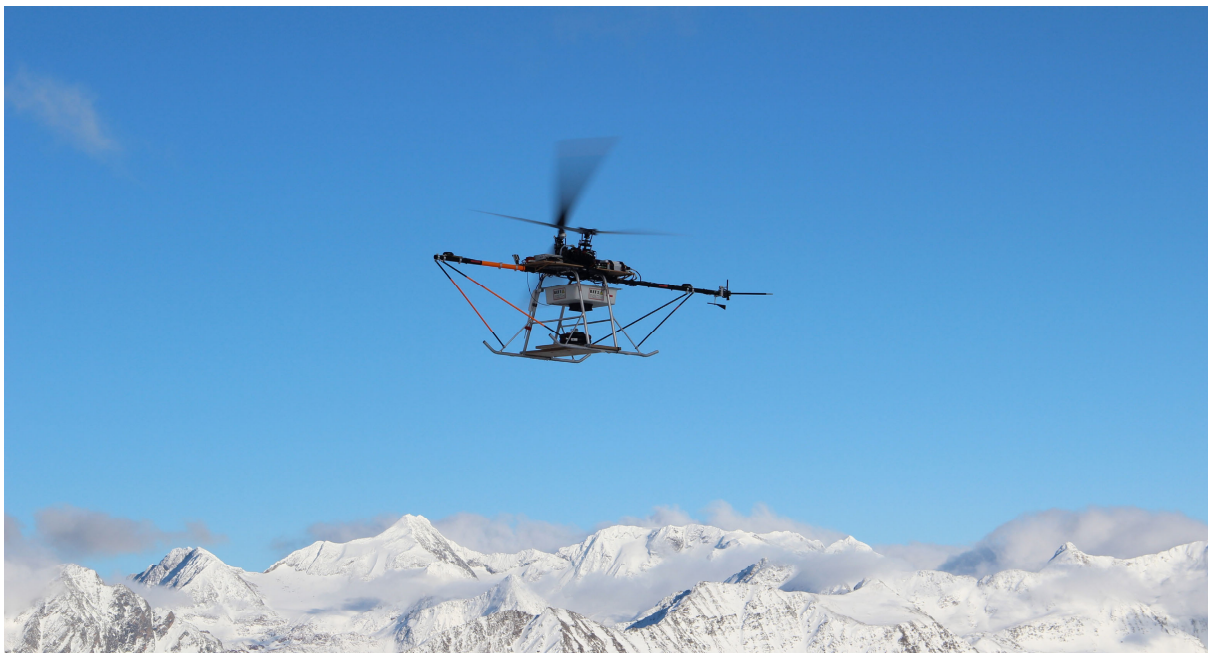
Abbildung 5-1: Schwebeflug auf 2800 m Höhe mit 20 kg Nutzlast und minimaler Drehzahl. EM/GM \approx 0,43 ; V_{tip} \approx 110 \text{ m/s} ; LMV_{el} \approx 105 \text{ W/kg} .
