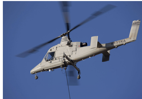
b) Unbemannter K-MAX ® (Foto: © 2010 Chad Slattery) Erstflug: 1999, MTOM \approx 5443 kg
