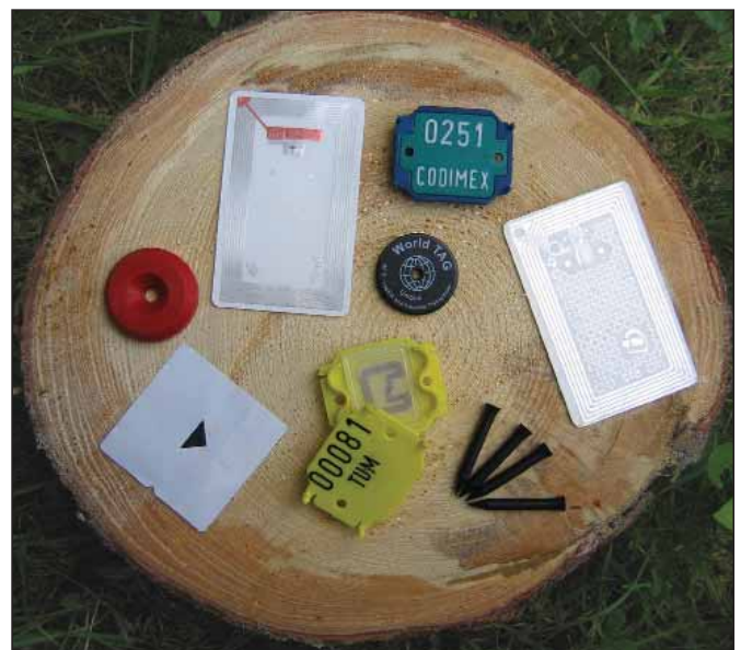
Abb. 1: Transponder gibt es in den unterschiedlichsten Formen. Nicht jeder Typ eignet sich jedoch für die Holzkennzeichnung. (Foto: S. Korten)
