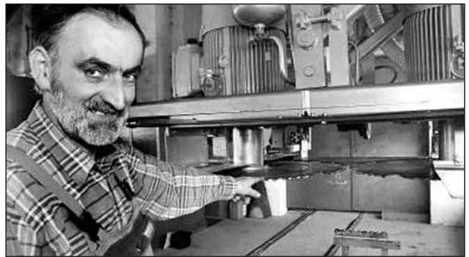
Abb. 1: Die beiden Sägeblätter mit je einem Meter Durchmesser - beide von eigenen Elektromotoren angetrieben - sind das Herzstück von Franz Osterholzers Erfindung. (Foto: K. Faßbinder)
