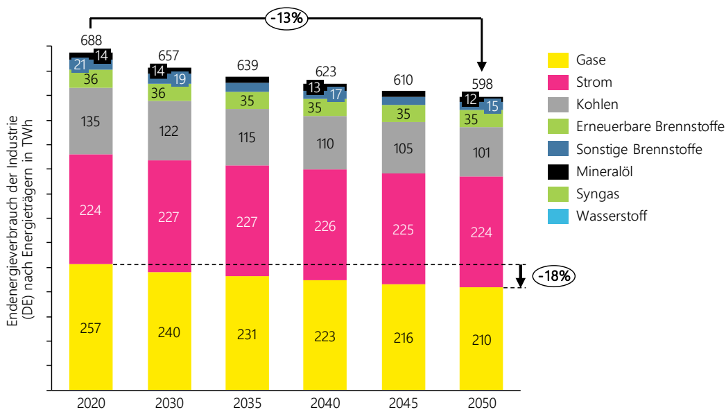
Abbildung 9-9: Entwicklung des Endenergieverbrauchs je Energieträger in der Industrie bis 2050 im Startscenario /BMWI-01 14/
