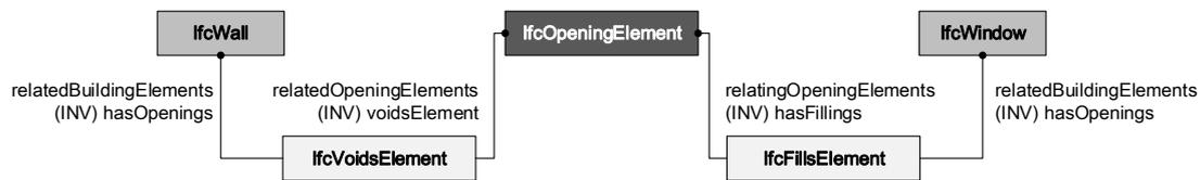
**Abbildung 2.5:** Das Prinzip der objektfizierten Beziehungen illustriert anhand des Beispiels Wand-Öffnung-Fenster; nach Borrmann et al. (2015a)
