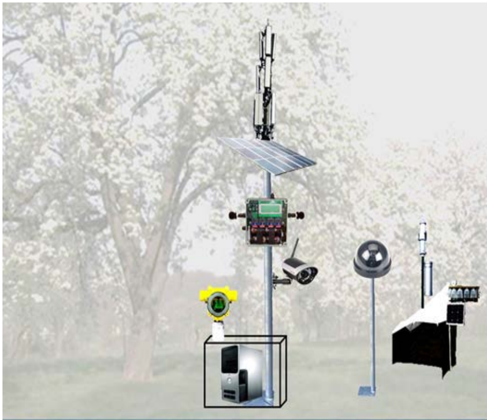
Abb. 1: Schematischer Aufbau einer AMMOD Station mit Datenerfassung, meteorologischen Sensoren, Sensoren für Tierstimmen, Kamerafallen für die Erfassung von Insekten und Vögeln, Probenahmeroboter für späteres DNA-Metabarcoding und einem GC-IMS für die Analyse der charakteristischen flüchtigen Metaboliten von Pflanzen.
