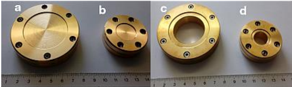
Abbildung 9: Übersicht der verschiedenen Filterhaltermodelle: a) 50 mm, massiv; b) 25 mm, massiv; c) 50 mm, mit Aussparung; d) 25 mm, mit Aussparung.
