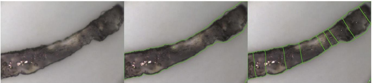
Abbildung 58: Beispielhaftes Bild einer PS-faser auf einem PC-Filter unter Hellfeldbeleuchtung; Box “white particles” inaktiv . (Lange Seite Einzelbild: ca. 1000 \mu\text{m} )
