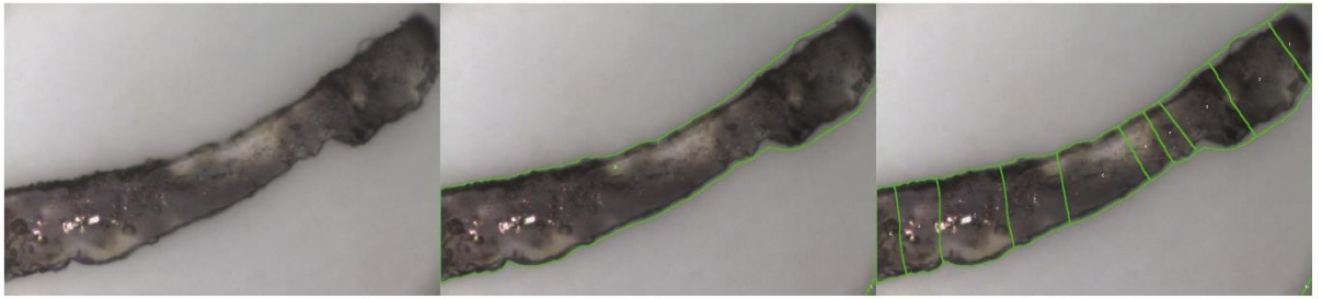
Abbildung 30: Beispielhaftes Bild einer PS-faser auf einem PC-Filter unter Hellfeldbeleuchtung; Box "white particles" inaktiv. (Lange Seite Einzelbild: ca. 1000 \mu\text{m} )
