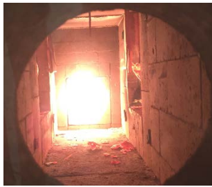
(a) Kleinbrandversuch OSB / MDF feuerzugewandt
