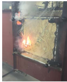
(b) Kleinbrandversuch OSB / MDF feuerabgewandt
