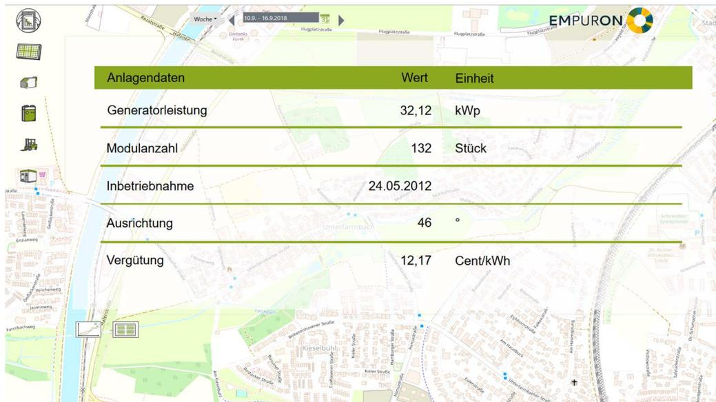
Abbildung II-41: Portaldarstellung Anlagenparameter
