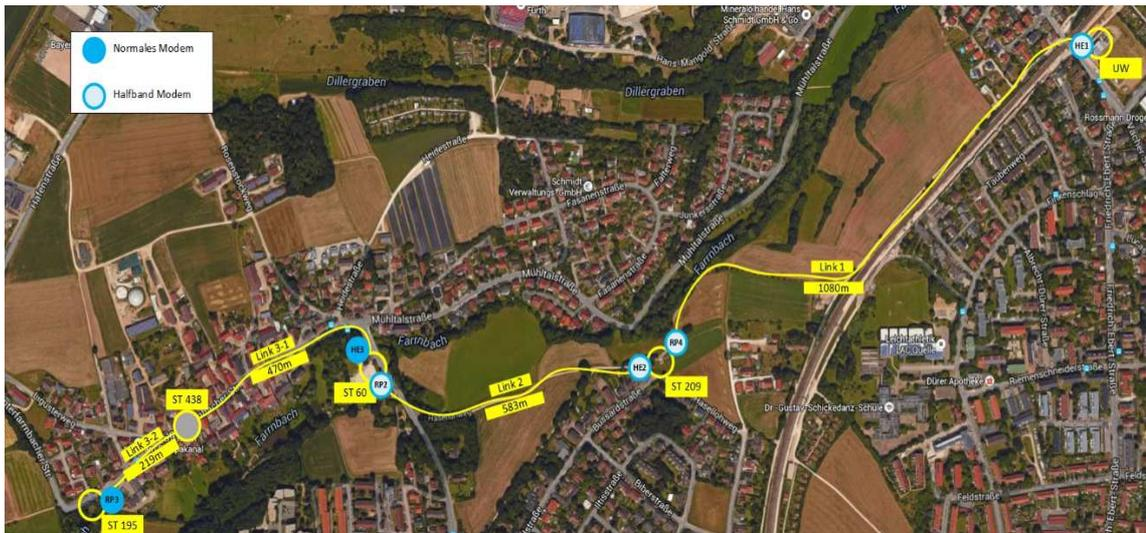
Abbildung II-82: Kommunikative Anbindung des NS-Netzes an das Backbone
