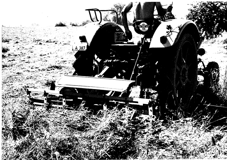
Mähen und Zetten in einem Arbeitsgang (Rüttelzetter von Streif)
