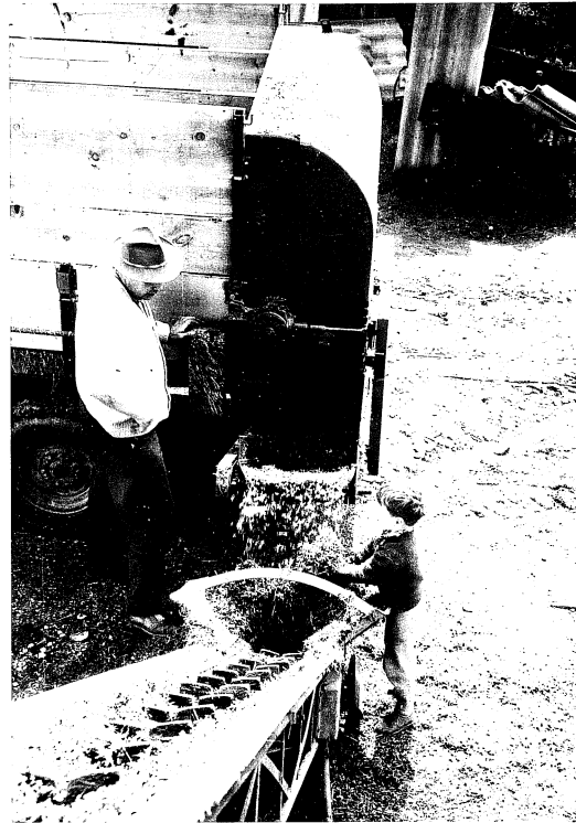
Selbstentladewagen mit Querförderband und Verteilerwalzen beim Beschicken eines Förderbandes.
