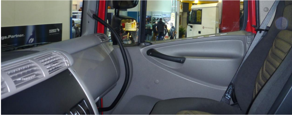
Abbildung 5-10: Ein zur Mitte der Türöffnung hin gebogener Haltegriff an der A-Säule (hier der Beifahrerseite des Tatra Phoenix) erleichtert das Einsteigen bei halbgeöffneter Tür
