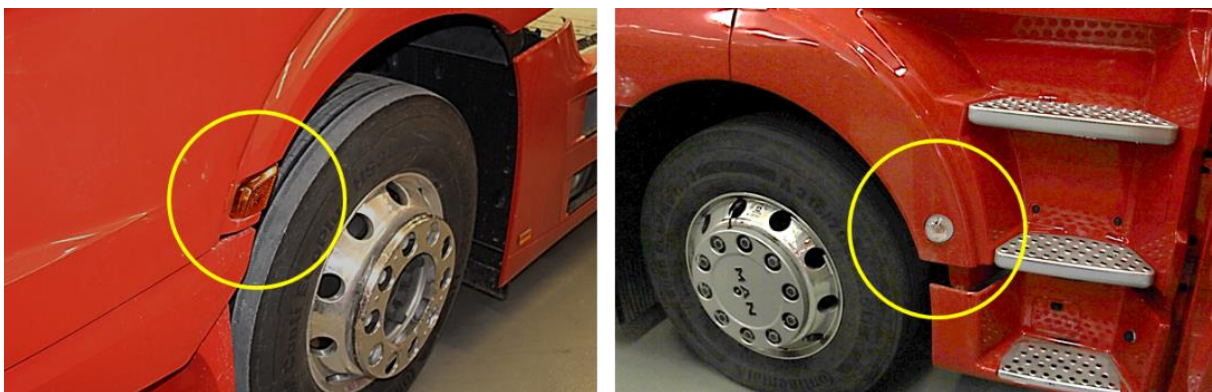
Abbildung 5-5: flach integrierte Blinkerwarze im Kotflügel (li) und hervorstehende Blinkerwarze (re) in Gelb eingekreist
