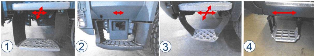
Abbildung 5-7: unterste Trittstufe bei Baustellenfahrzeugen (Sawade, 2017)
