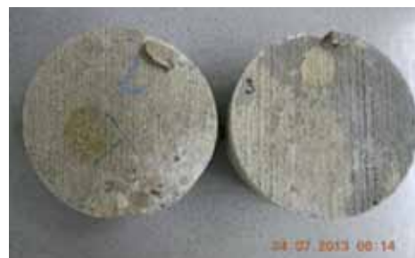
Bild 4: Betonoberflächen nach der Säurebehandlung
