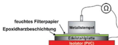
Bild 3 Schematische Darstellung des Versuchsaufbaus zur Bestimmung des Beschichtungswiderstands
