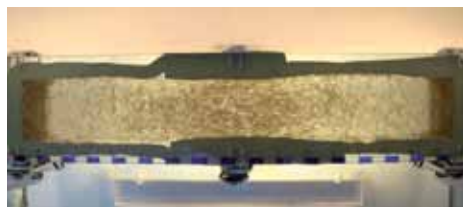
Bild (bei 500 U/min rotiertes Gel, Ansicht von oben auf die Prismenschalung)
