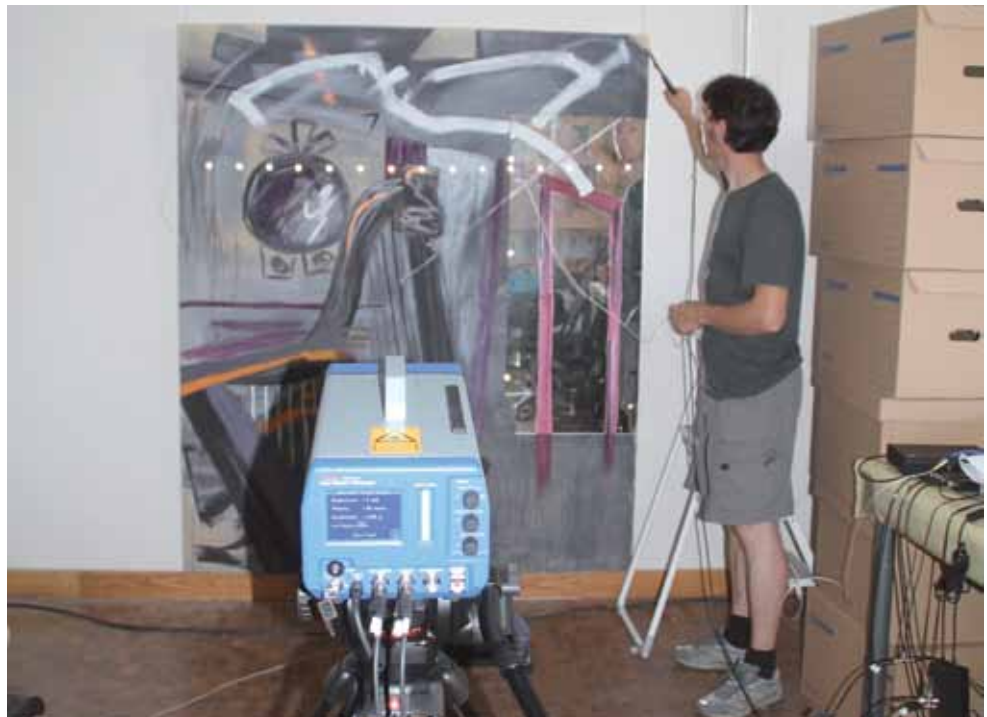
Bild 1: Durchführung einer Schwingungsanalyse an einem Gemälde.
