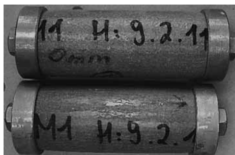
Abbildung 1: Vergleich zwischen freier (oben) und behinderter Dehnung (unten) für Hohlörtelzylinder nach 90 d in einer Sulfatlösung (30 g/L \text{SO}_4 )
