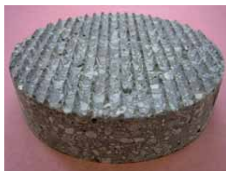
Abb. 6: Grindingtextur der Betone 1 (links) und 2 (rechts); Wellenbesatz beim Grinding beider Betone: Segmentbreite 3,2 mm, Distanzscheibenbreite: 5,0 mm
