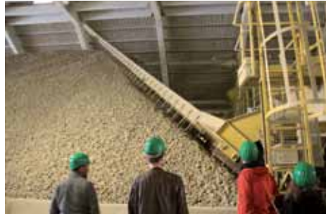
Bild 14: Homogenisierung der Rohschotter in Mischbetten
