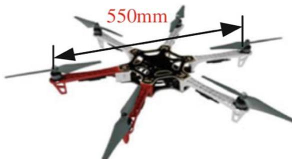
Abbildung 7: diagonale Größe des Hexakopters F550 von DJI (Quan, 2017)
