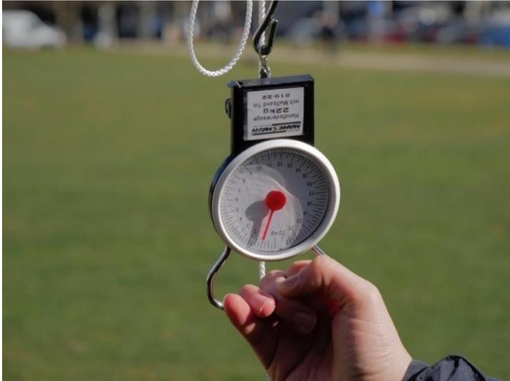
Abbildung 26: Messung des maximalen Schubs
