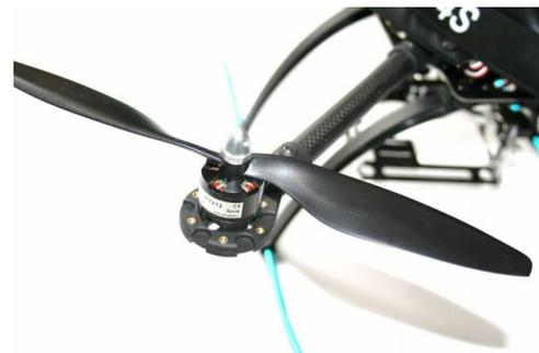
Abbildung 11: Motor eines Multikopters mit Festpropelle (Liang, 2015)
