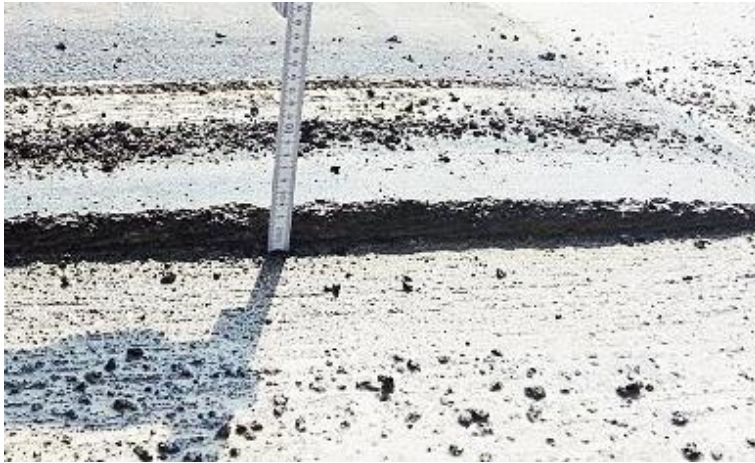
Bild 7.36: Stichmaßbestimmung am Asphaltstreifen mit Kuppenbildung [21]
