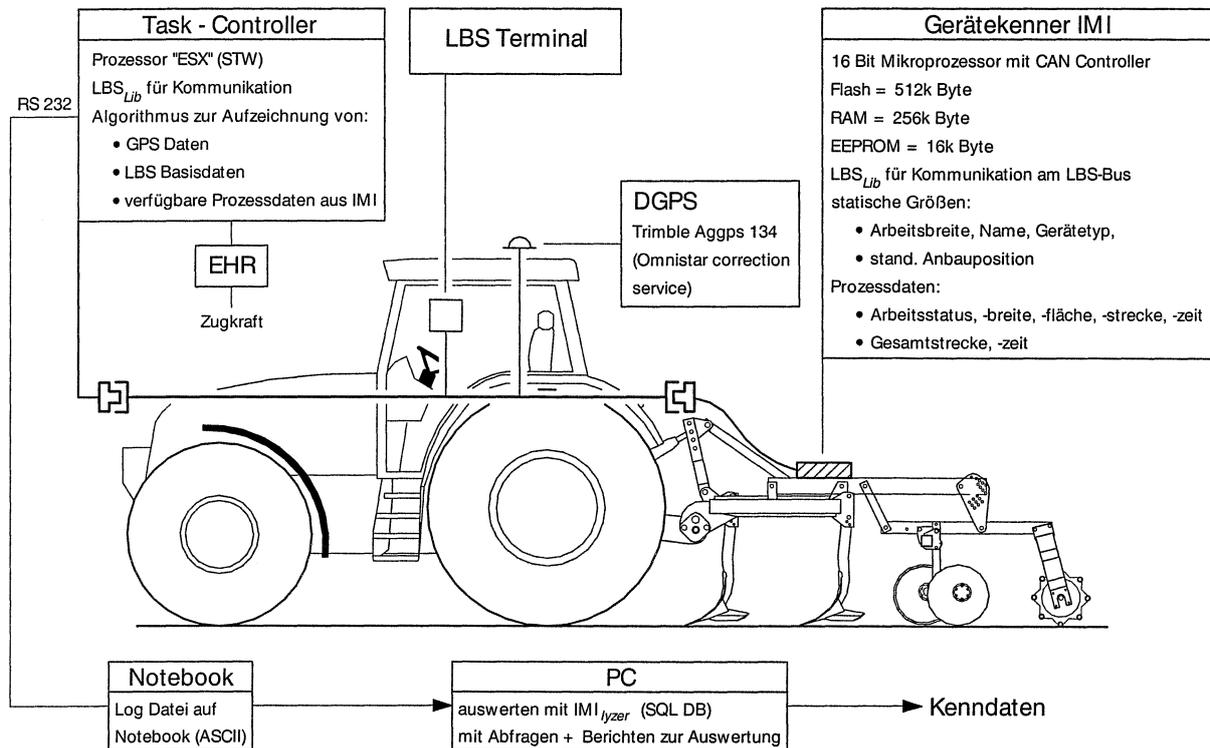
Abbildung 4: Prinzip der automatischen Datenerfassung mit GPS, LBS und IMI in einer Traktor-Gerätekombination
