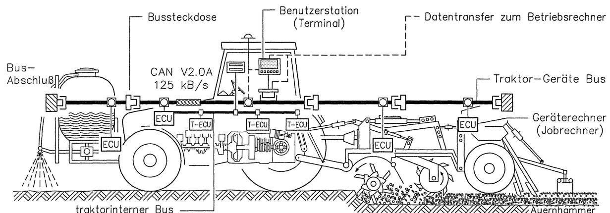
Abbildung 2: Schematischer Aufbau von LBS nach DIN 9684/2-5
