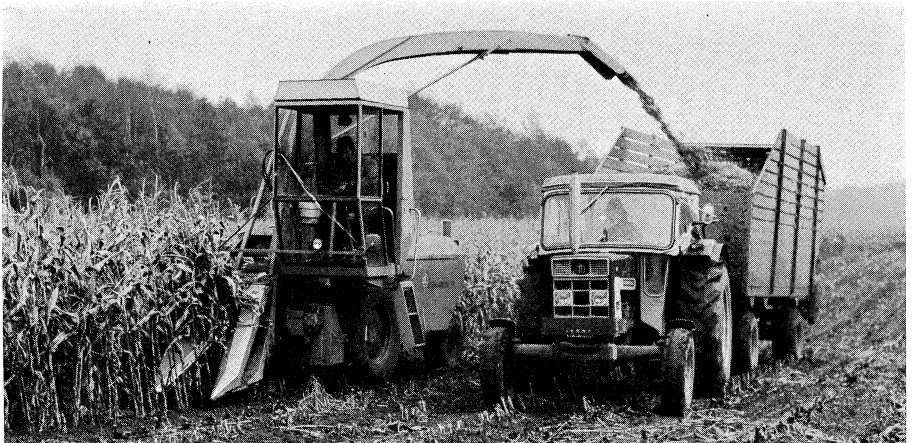
Abbildung 4: Selbstfahrender, dreireihig arbeitender Häcksler im Umhängebetrieb (Werkbild: Claas)
