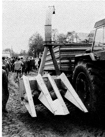
Abbildung 3: Moderner, zweireihig arbeitender Silomaishäcksler für Seiten- und Heck- bzw. Front-Anbau
