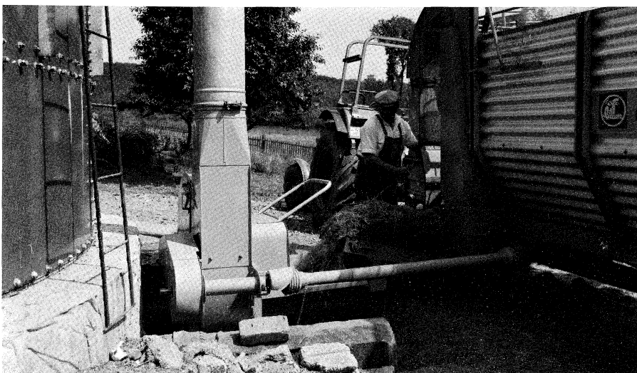
Abbildung 2: Silageeinlagerung mit Selbstentladewagen, Gebläse und Zapfwelldurchtrieb (Werkbild: Claas)
