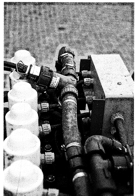
Bei Dos-Intro, der Erfindung eines bayerischen Landwirtes, kann man wie bei Öko-Lok den Wasserstrom und die Einspeisung getrennt regeln. Eingespeist wird unmittelbar vor der Teilbreite. An der konstanten Dosierung muß bei diesem Gerät jedoch noch gearbeitet werden.
