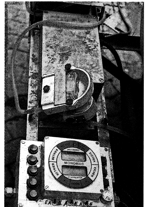
Öko-Lok von Biotronik läßt sich wie ein Baukasten erweitern. Wasser und Mittel lassen sich getrennt regeln, so daß die Konzentration der Spritzbrühe laufend angepaßt werden kann (wenn auch vorerst nur per Hand). Verglichen mit Agroinject, kommen mehr Bauteile mit Pflanzenschutzmitteln in Berührung.
