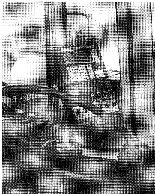
Wenn die Spritze durch die Elektronik überwacht und bedient wird, kann bei geschlossener Kabine gearbeitet werden. Foto: Peter
