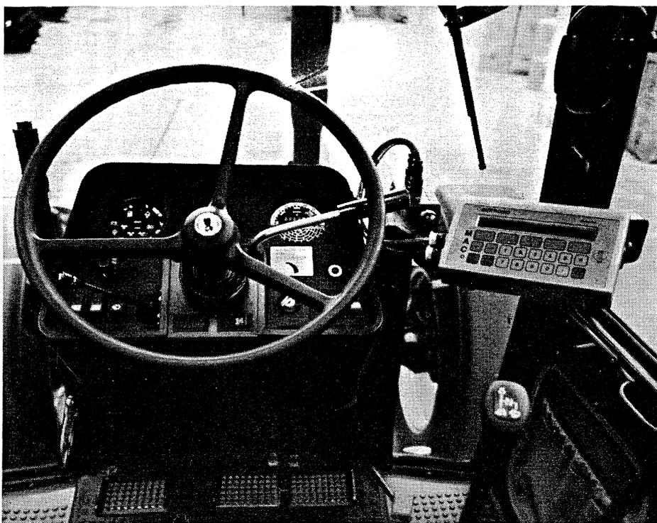
Traktorterminal, hier von Case IH, ermöglicht die Kontrolle aller Steuerungs- und Anzeigefunktionen vom Fahrersitz aus.
