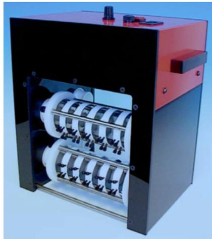
**Abbildung 7: Dialyse-Stativ mit zwei Trägerapparaturen (The Nest Group, I)**
