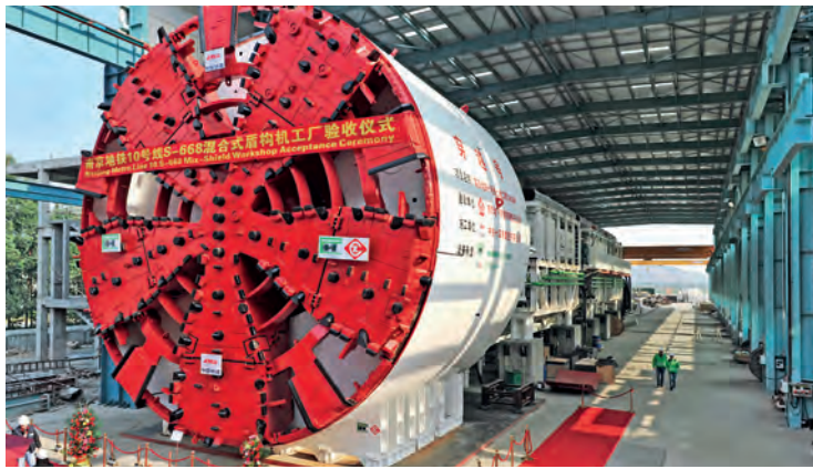
Der Herrenknecht Mixshield S-668 (Ø 11.610 mm) anlässlich der Werksabnahme in Nansha, Guangzhou, China.
