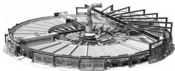
Abbildung 20 Funktionsprinzip und Abbildung eines Karussellfilters zur Gipsfiltration in der Phosphorsäureherstellung; [99] [98]
