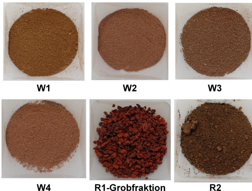
Abbildung 38 In dieser Arbeit untersuchte Klärschlammaschen. Bei R1 ist die abgesiebte Grobfraction ( > 2 \text{ mm} ) abgebildet, W2 und W4 stammen aus der gleichen Anlage; eigene Darstellung
