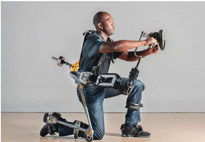
Exoskeleton „Fortis“ der Firma Lockheed Martin für Ausbaurbeiten.
