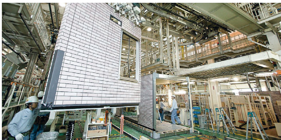
Vorfertigung auf Basis einer hochautomatisierten Produktionslinie bei Sekisui Heim in Japan.
