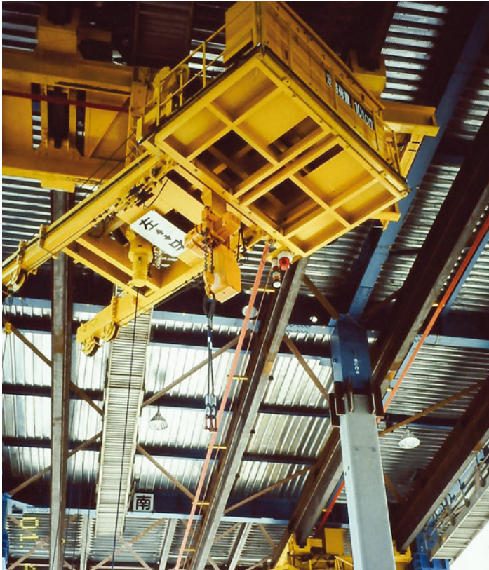
Robotereinsatz in einer automatisierten Hochbaustelle durch das japanische Bauunternehmen Obayashi.
