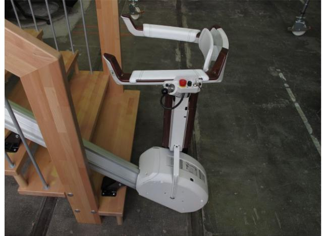
Abbildung 2: Der StairWalker, der Unterstützung beim Treppensteigen gibt, aber den Nutzer erlaubt, selber die Stufen zu steigen und dadurch auch einen Trainingseffekt hat.
