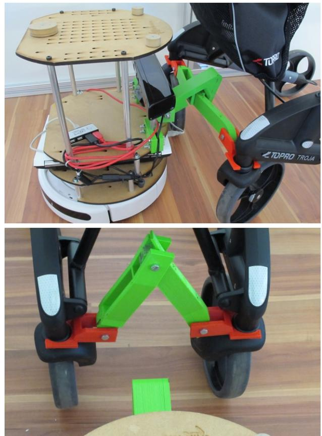
Abbildung 5: *Oben* verwendet der TurtleBot den Rollator-Roboter-Konnektor um den Rollator zu transportieren, *unten* ist dargestellt, dass der Rollator-Roboter-Konnektor so konzipiert ist, dass die normalen Funktionen des Rollators nicht eingeschränkt werden.
