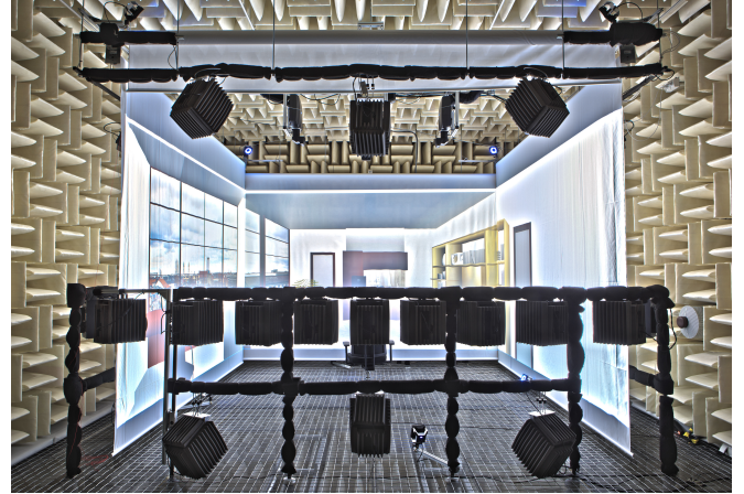
Abbildung 1: Das Lautsprecherarray des rtSOFE. Verwendet wurde der horizontale Teil des Arrays. Foto von Bernhard Seeber.
