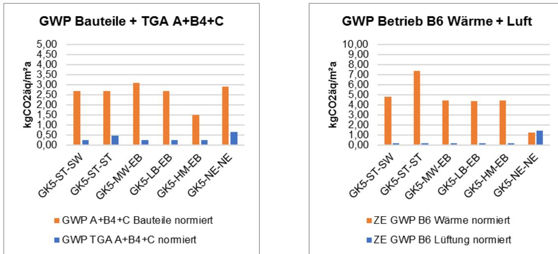
Abbildung 3: Gebäudeklasse 5 GWP Bauteile + TGA und Betrieb pro m<sup>2</sup> NF
