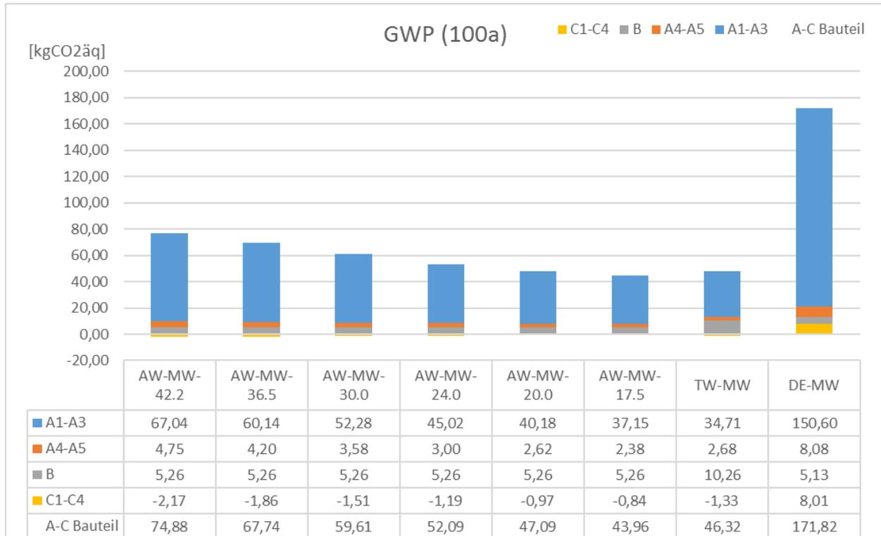
Abbildung 55: Vergleich des GWP pro m<sup>2</sup> der jeweiligen Bauteile
