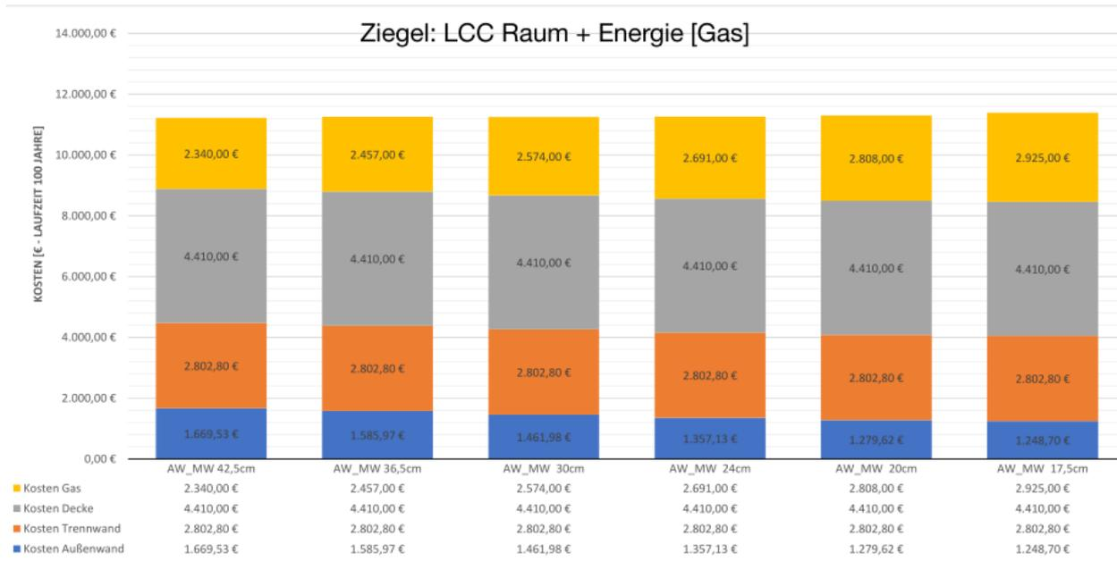
Abbildung 62: LCC best-case Ziegel inklusive Heizwärme über 100a
