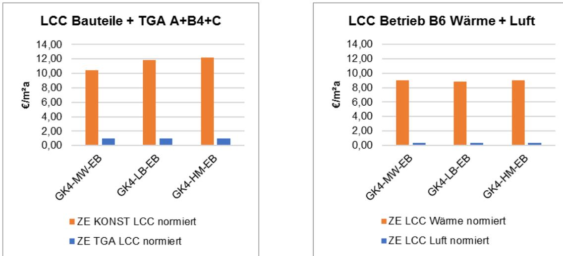
Abbildung 15: Gebäudeklasse 4 LCC Bauteile + TGA und Betrieb pro m<sup>2</sup> NF und a
