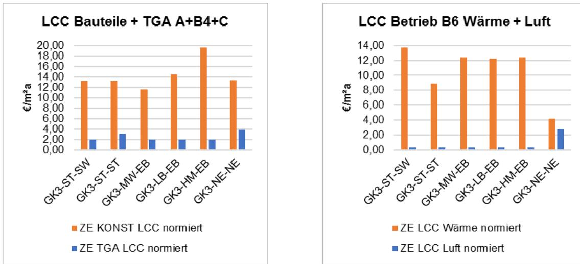
Abbildung 6: Gebäudeklasse 3 LCC Bauteile + TGA und Betrieb pro m<sup>2</sup> NF und a
