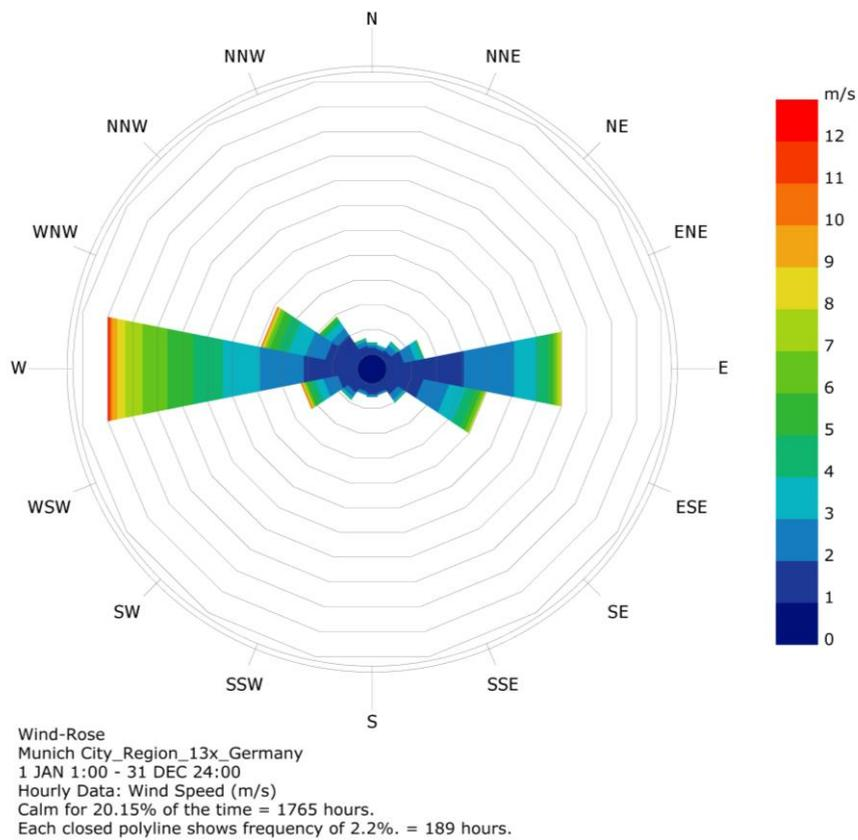
Abbildung 38: Windrose mit Angabe der Windgeschwindigkeit (Farbskala)
