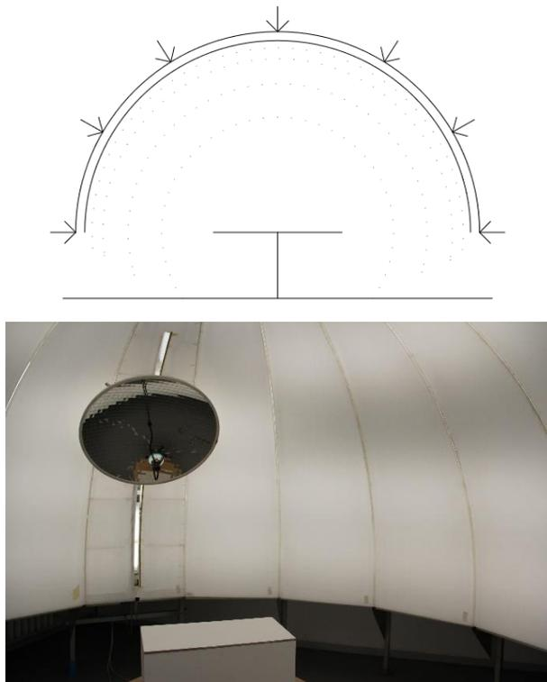
Abbildung 90: links: Erklärungsgrafik zur Funktionsweise des Lichthimmels, rechts: Fotografie des Kuppelinneren des Lichthimmels
