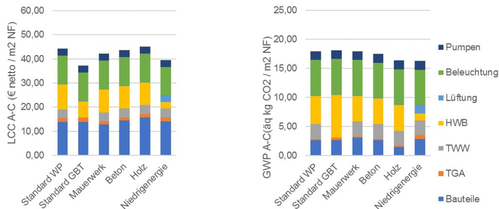
Abbildung 75: Monostoffliche „Einfache Bauten“ GK5 (Blockrand/Baulücke) pro m<sup>2</sup> NF und a
