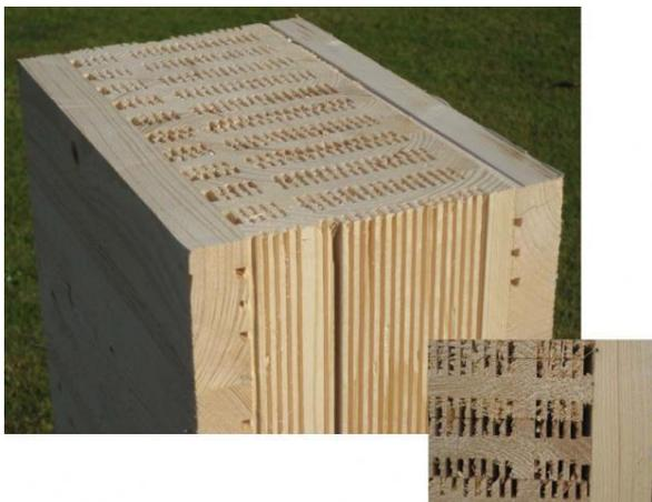
Abbildung 16: Vollholzelemente aus Blockständern mit Luftkammern (Reßle, 2018).
