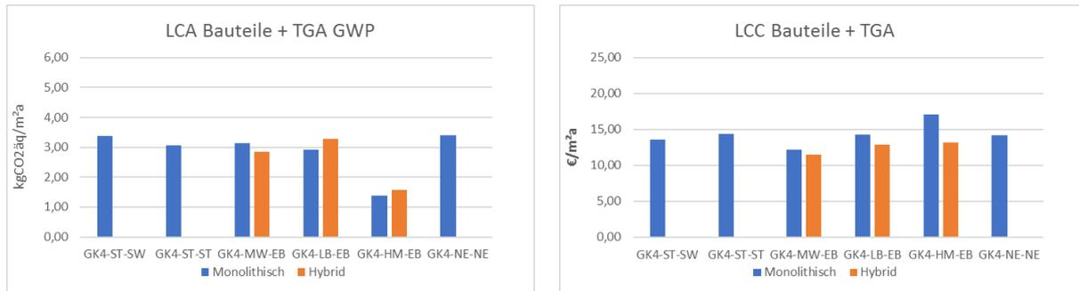
Abbildung 80: Gebäudeklasse 4 LCA & LCC Bauteile + TGA pro m<sup>2</sup> NF und a
