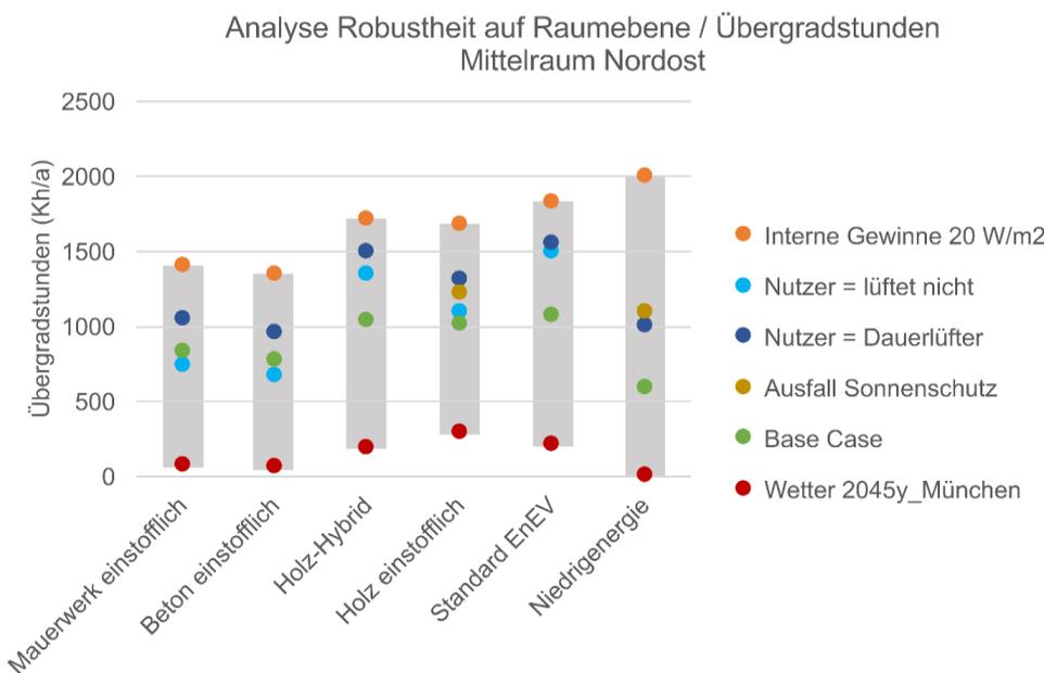
Abbildung 53: Robustheit der Varianten bezüglich ihres Sommerlichen Wärmeschutzes (Beispiel Mittelraum Nordost)
