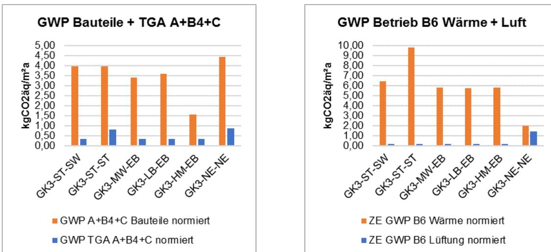
Abbildung 1: Gebäudeklasse 3 GWP Bauteile + TGA und Betrieb pro m² NF
