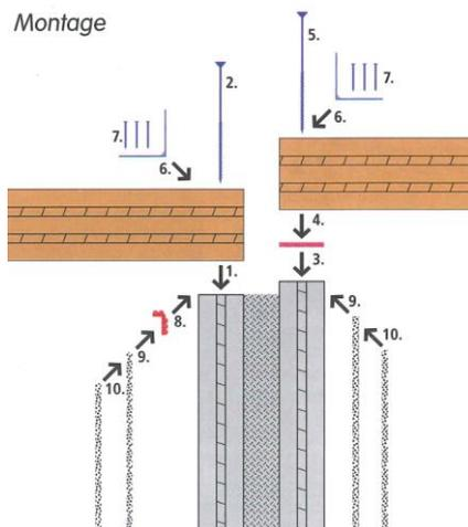
Abbildung 13: Positionierung des entkoppelnden Schalldämmelements (rot) in der Montagefolge (Borsch-Laaks et al., 2018)
