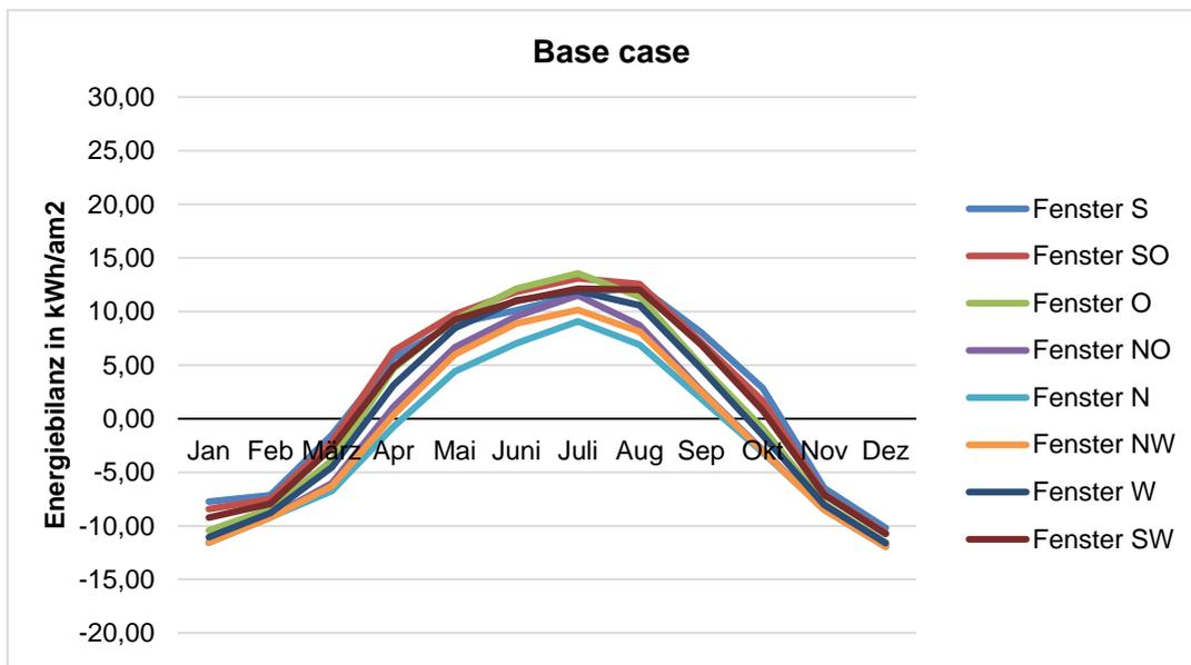
Abbildung 28: Energiebilanz der einzelnen Himmelsrichtungen für den Base case
