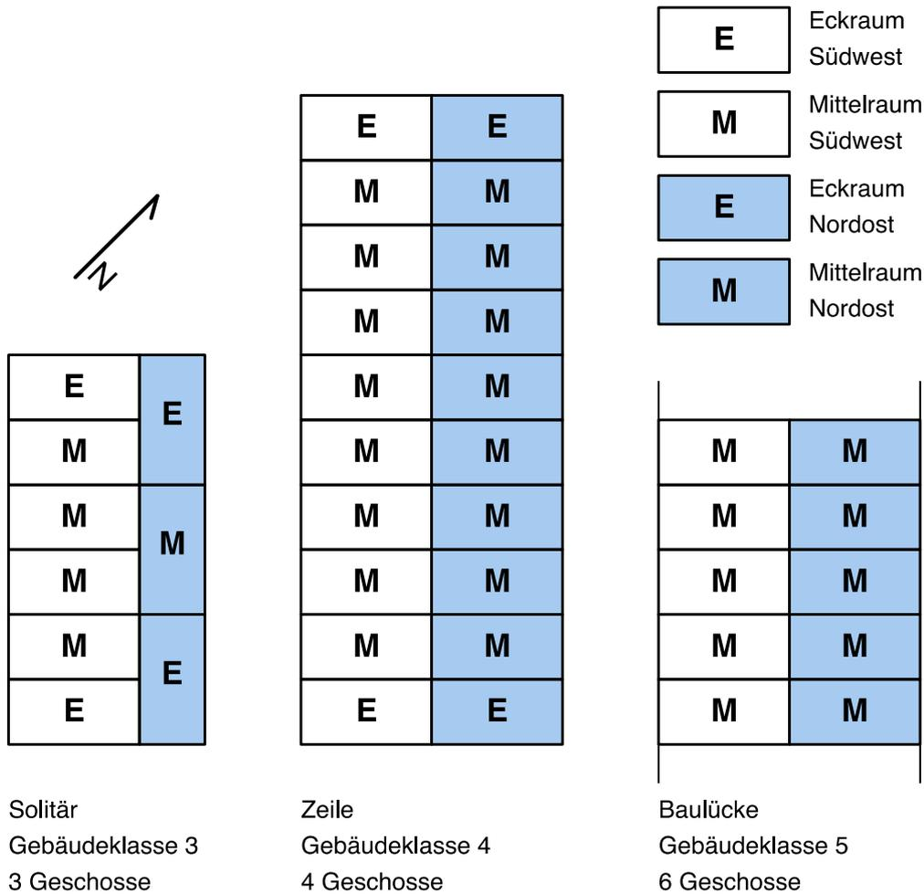
Abbildung 83: Schema der Aufgliederung der Grobentwürfe in Raummodule
