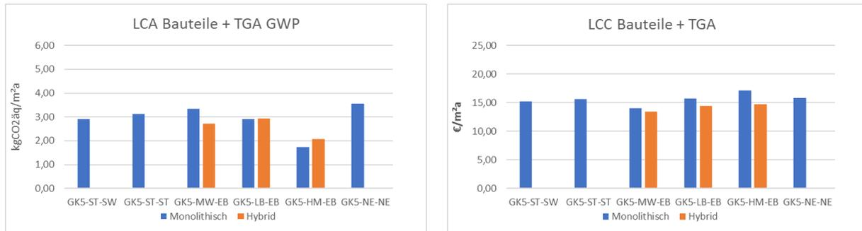
Abbildung 81: Gebäudeklasse 5 LCA & LCC Bauteile + TGA pro m<sup>2</sup> NF und a
