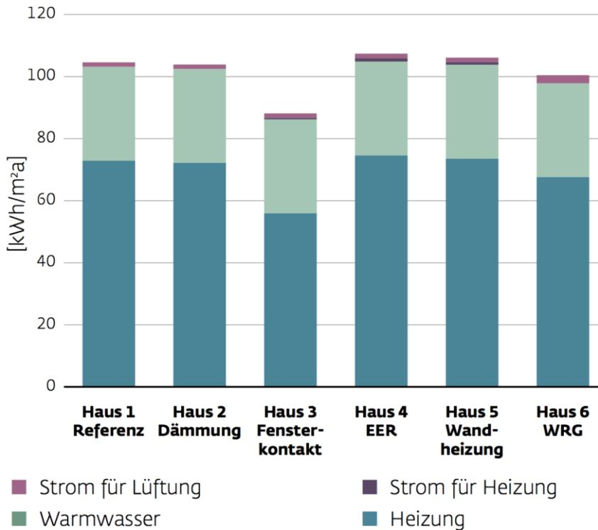
Abbildung 82: Nutzenergieverbrauch verschiedener Gebäudetechnikkonzepte im Vergleich, Quelle: (GEWOFAG, 2016)
