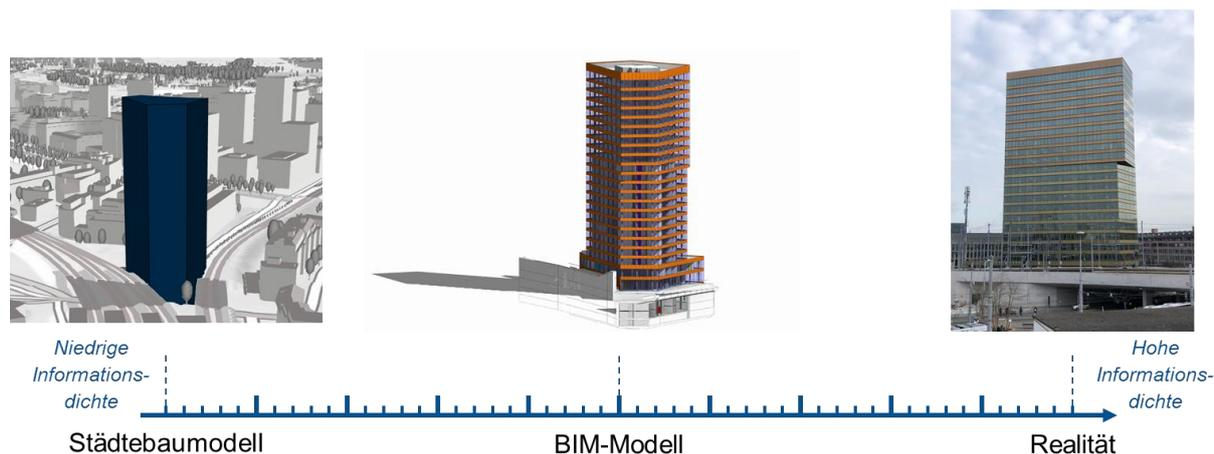
Abbildung 3-7 Detaillierung der Realität am Beispiel des Andresturmes in Zürich (BIM-Modell: Implenia intern)
