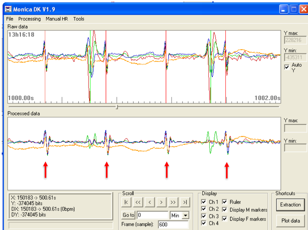
Abbildung 4 Extraktion der Rohdaten zur Ermittlung der fetalen QRS-Komplexe (Bildschirmfoto, Monica Healthcare Ltd, 2009) oben: Rohdaten einer 2 Sekunden-Sequenz in allen 4 Kanälen unten: extrahierte Daten mit Anzeige der fetalen Komplexe (rote Pfeile)
