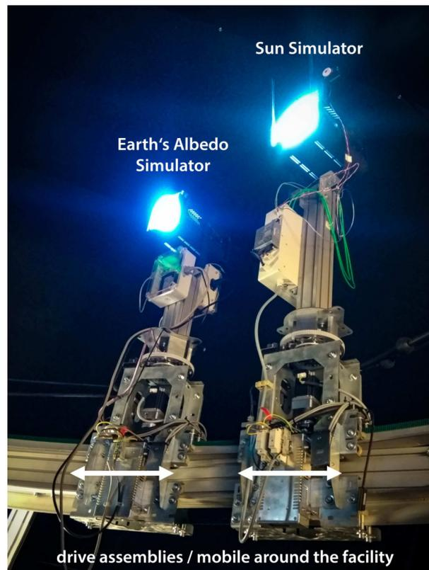
**Abb. 1–2: Sonnen- und Erdalbedosimulator im ursprünglichen Zustand. Beide befinden sich im eingebauten Zustand auf der Schienenkonstruktion. An der Unterseite befinden sich die Antriebseinheiten, mit welchen sich die Simulatoren auf der Schiene verfahren lassen. Direkt unterhalb der Leuchtmittel befinden sich die Gehäuse mit EVG, Zündgerät und Steuerung. Unterhalb dieser befindet sich die Stromversorgung.[3]**
