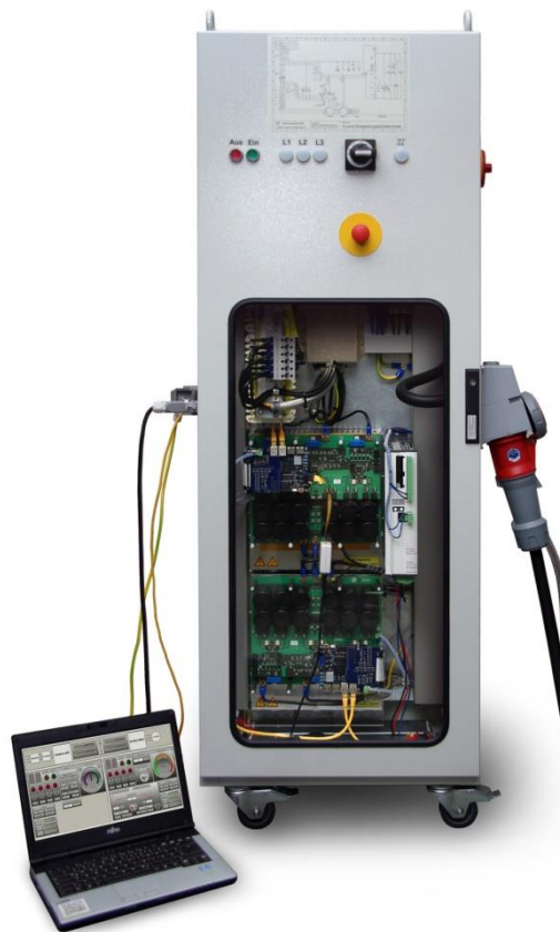
Abbildung 7.2: Foto des Schaltschranks und der auf einem Laptop laufenden grafischen Benutzeroberfläche
