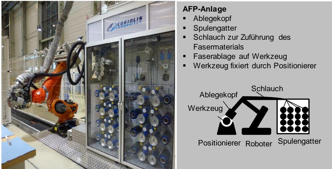
Abbildung 43: Automated Fiber Placement (AFP)-Prozess
