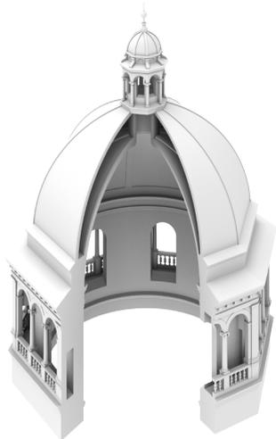
Abb. 4: Schnitt durch Grat/Rippe, Mittelachse (SN).
