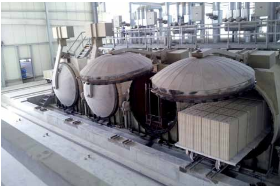
Bild 6: Härtung der Steinrohlinge in Autoklaven
