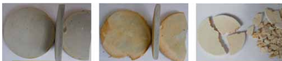
Abbildung 2: Korrodierte Scheiben nach 28 d in HCl bei verschiedenen pH-Werten.
