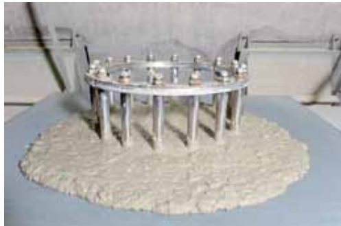
Bild links: Fließmaßversuch Bild rechts: Beton fließend Fotos: Heike Geigl
