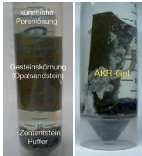
Abbildung 1: Lagerung der Gesteinskörnung in künstlichen Porenlösungen (links) und AK-Gelbildung auf der Oberfläche eines Opalsandsteins nach 91 d Beanspruchung (rechts)
