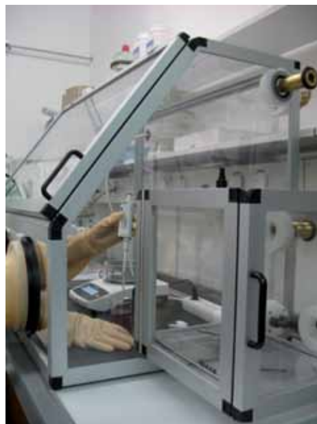
Bild 1: geschädigter Betonbohrkern mit fluoreszierendem Kunst- harz imprägniert und unter UV-Licht (links), Glovebox für CO 2 -freie Pro- benbearbeitung (rechts)
