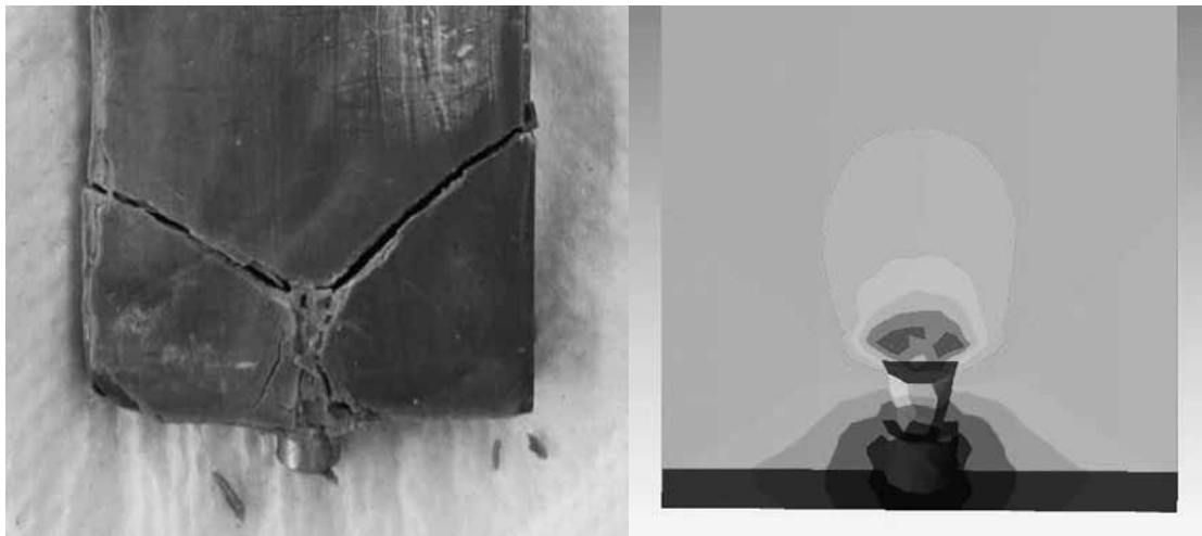
Abb. 1: Vergleich der Rissbildung im Bereich der Messzapfen eines Zementstein-Flachprismas in Laborversuch (links) und FE-Modell (rechts, Spannungsverteilung). Die Lagerung des Probekörpers im Laborversuch fand analog dem SVA-Verfahren in einer Natriumsulfatlösung ( \beta(\text{SO}_4^{2-}) = 30 g/L) statt. Das Bindemittel ( w/b = 0,5 ) des Flachprismas wurde aus 64 M.-% CEM I 42,5 R und 36 M.-% Hüttensand hergestellt.
