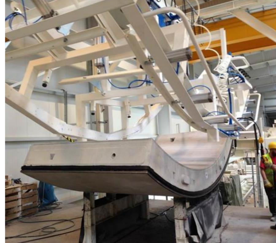
links: Tübbing in der Produktion mit Blick auf die Tübbinglängsfuge; rechts: Tübbingtunnel im einschaligen Ausbau (Längsfugen blau nachgezeichnet)
