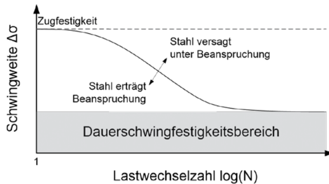
Abbildung 1: Schematische Darstellung der Wöhlerlinie für einen Stahl
