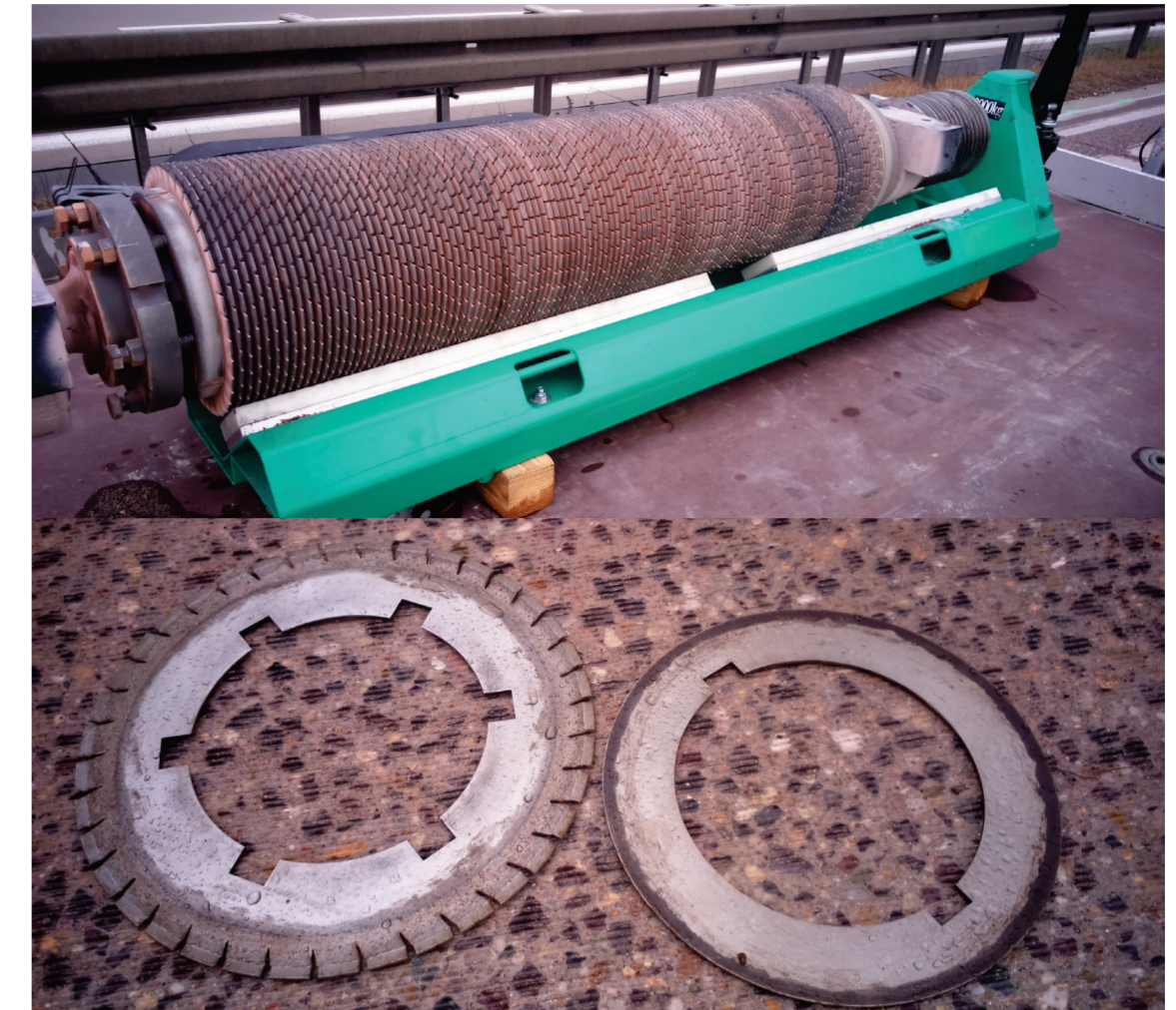
Besetzte Grindingwelle (oben) mit den zugehörigen Schleif- und Distanzscheiben (unten)
