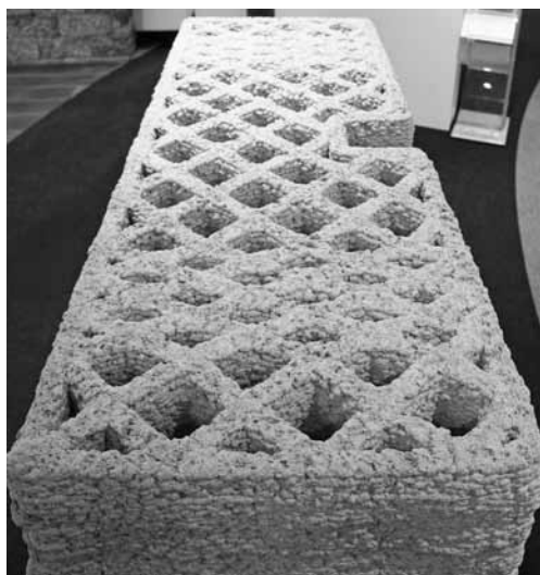
Abbildung 13: Multifunktionales Wandelement aus Holzfaserbeton (Foto: D. Weger)
