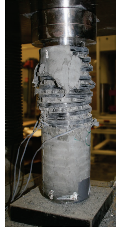
Repräsentative Last-Weg-Verläufe aus den statischen Kurzzeitdruckversuchen für unterschiedliche Umschnürungsdicken t_w und Prüfkörperdurchmesser d (Mitte) und exemplarische Versuchskörper unmittelbar nach dem Ende des Versuches (links und rechts)
