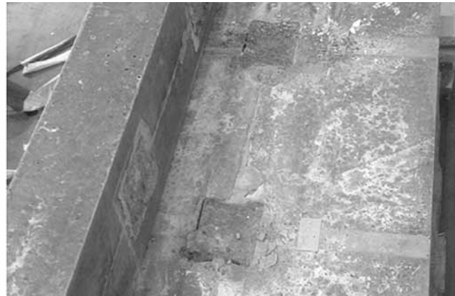
Abbildung 12: Last-Verformungs-Beziehungen (links) und typisches Bruchbild der abgesicherten Schubnocken
