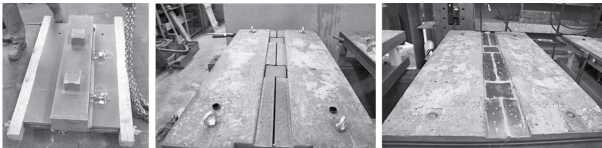
Abbildung 11: Push-Out Versuchskörper mit schwalbenschwanzförmigen Schubnocken für den Anschluss zwischen Fahrbahnplatten und Längsträgern; links: Längsträgerausschnitt mit Schubnocken, mittig: zusammengesetzte Elemente vor Fugenverguss, rechts: fertige Anschlusskonstruktion nach Fugenverguss
