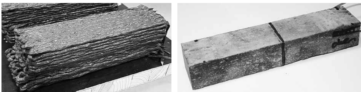
Abbildung 3: Gedruckte Prüfkörper ohne Nachbearbeitung und mit geschliffener Oberfläche
