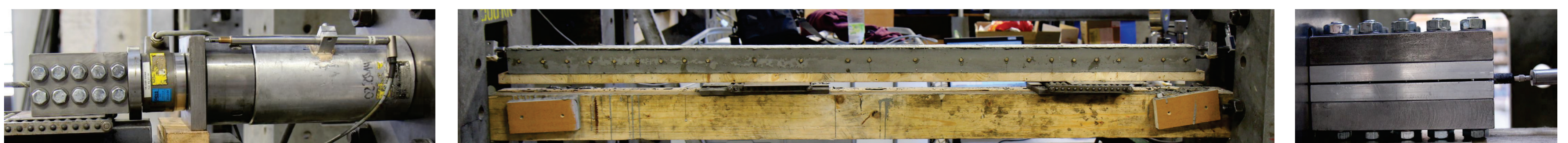
Spannkrafteinleitungsversuch mit CFK-Stab: Detail der linken Endverankerung mit CFK-Stabende, Klemmverankerung, Kraftmessdose und Zylinder (links), Betonkörper mit Messmarken (Mitte) und Detail der Klemmverankerung am rechten Stabende (rechts)
