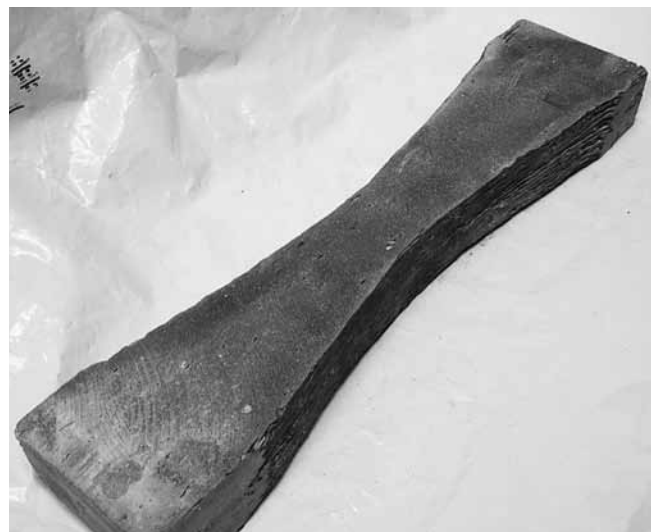
Abbildung 6: Zugknochengeometrie und Prüfkörper
