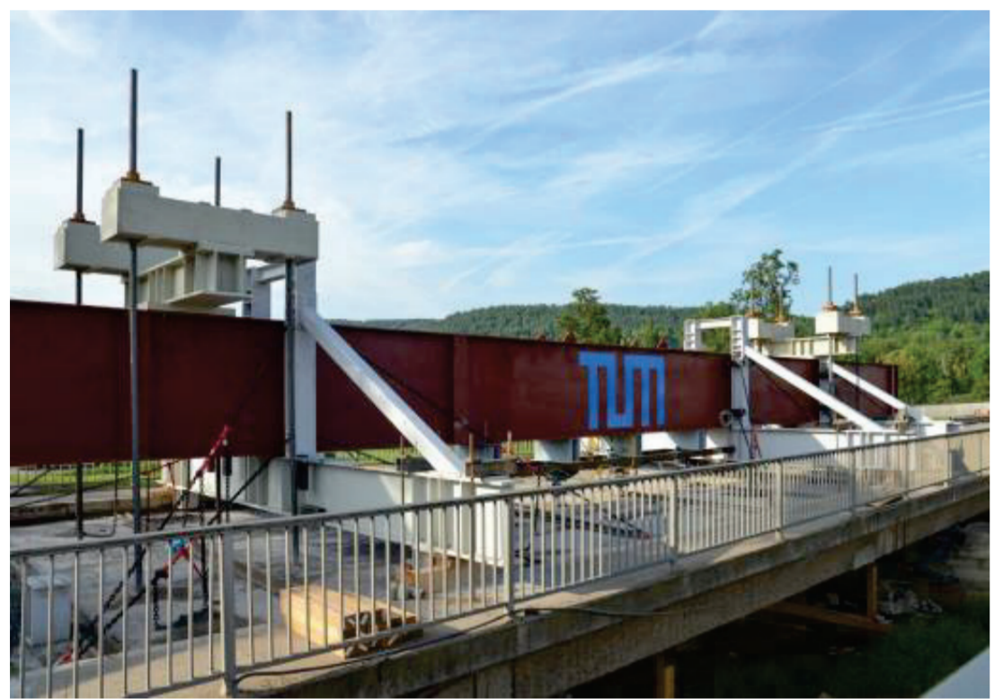
Versuchsaufbau an der „alten Saalebrücke“ Hammelburg im Prüfzustand mit 31,65 m langen Hauptbelastungsträger, vertikaler Abspannung (Achse B und H), seitlicher Kippsicherung und hydraulischen Belastungszylindern (links und Mitte) sowie Messtechnik vor Versuchsbeginn mit Kameraschiene für die optische Messung, faseroptischen Sensoren und Seilzugpotentiometern (rechts)
