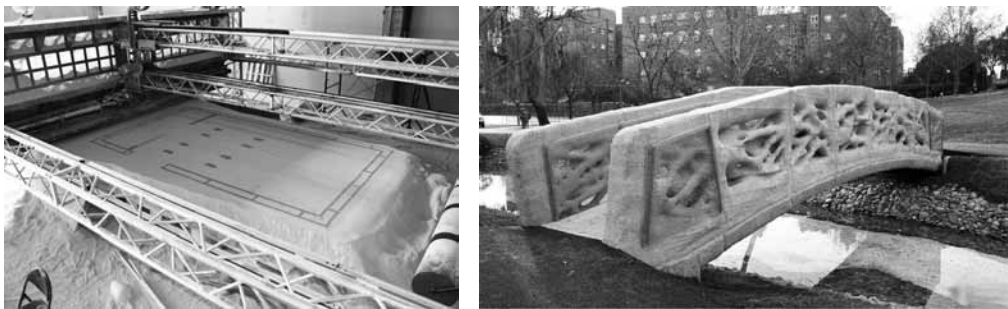
Abbildung 11: links: D-Shape: Druckportal [30], rechts: Fußgängerbrücke in Madrid [31]
