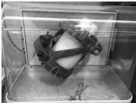
Abbildung 1: Taumelmischer (links), verdichtete und getrocknete Rohmehlzylinder (rechts)
