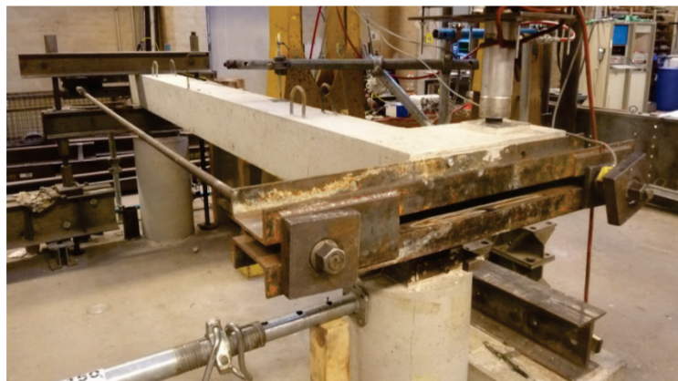
Versuchskörper T10 (wölbehindert) vor der Prüfung
