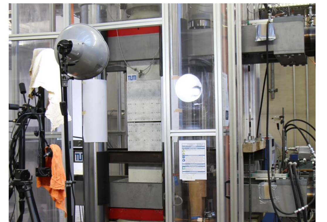
Vordergrund: Nahfeldphotogrammetriesystem; Hintergrund: Versuchsaufbau mit eingebautem Versuchskörper
