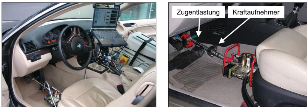
Abbildung 2-22 Bremsroboter mit hydraulischer Betätigung im Pkw (links: Prototyp, rechts: überarbeitete Ausführung [2, S. 45]).
