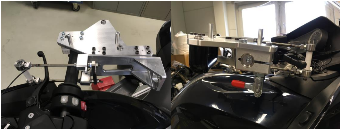
Abbildung 6-19 Montage des mechanischen Aufbaus und der Hebelbetätigung der vorderen Messeinrichtung am Fahrzeug.
