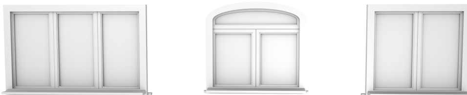
Abbildung 8.27: Auf Basis des gezeigten Ansatzes könnte beispielsweise auch ein herstellerspezifischer Fenstergenerator implementiert werden, der auf Basis von Eigenschaftswerten unterschiedliche Geometrien erzeugt.
