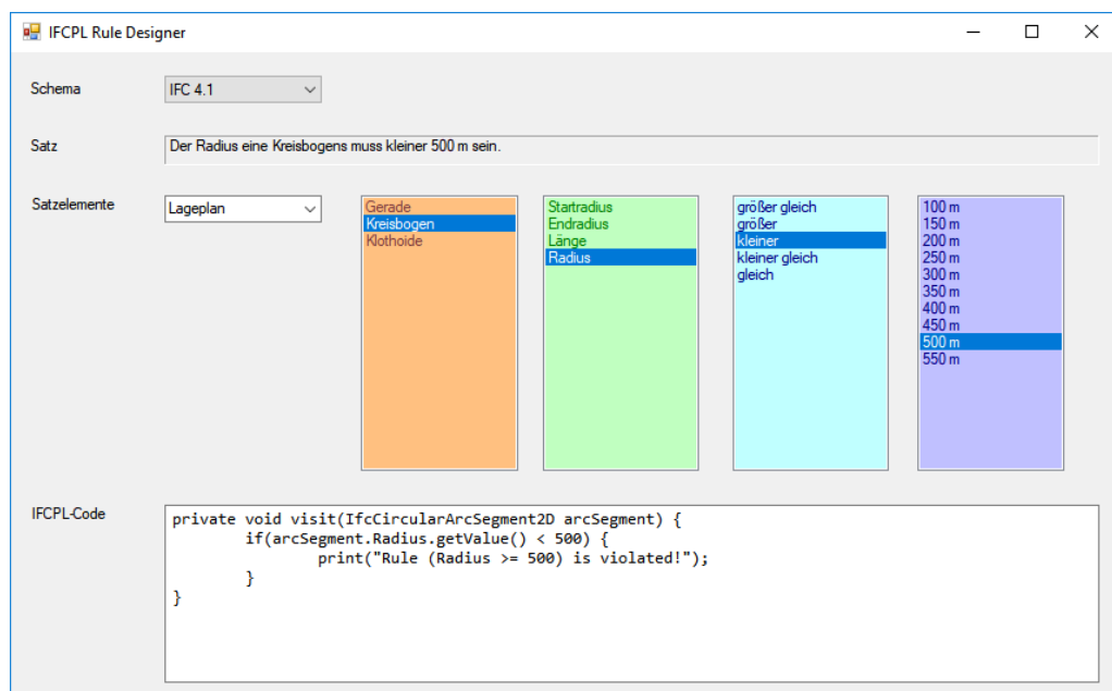
Abbildung 8.33: Prototypischer Codegenerator, der auf Basis vorgefertigter Satzbausteine IFC-PL-Prüfcode generiert
