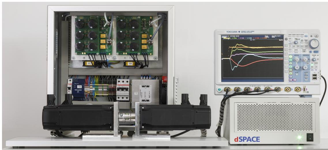
Abbildung 7.1: Prüfstand mit drehelastisch gekoppelter Antriebs- und Lastmaschine
