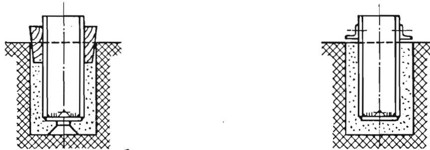
Bild 1 Köcherfundamente für eingespannte Stützen
