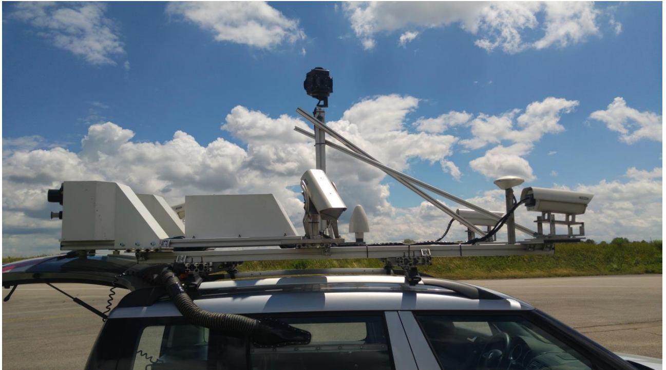
Abbildung 4.1 – Aufbau des Mobile Mapping Systems MoSES (Bildquelle: 3D Mapping Solutions)
