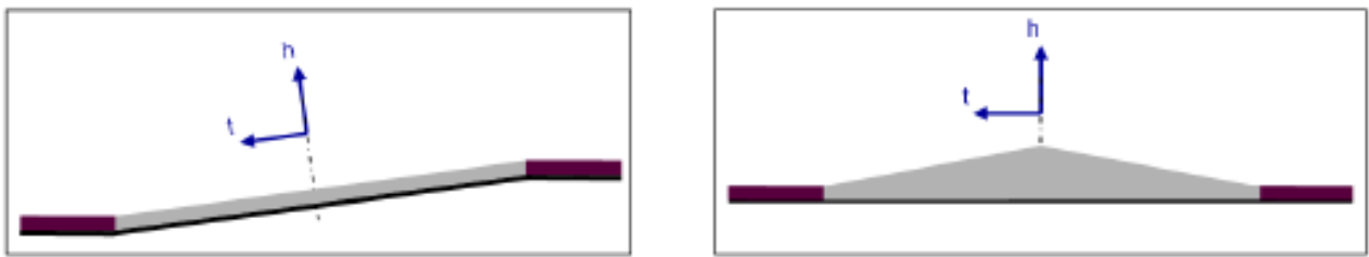
Abbildung 3.5 – Querschnitte mit Überhöhung (links) und Querneigung (rechts) in OpenDRIVE [Dupuis et al., 2015, S.23]
