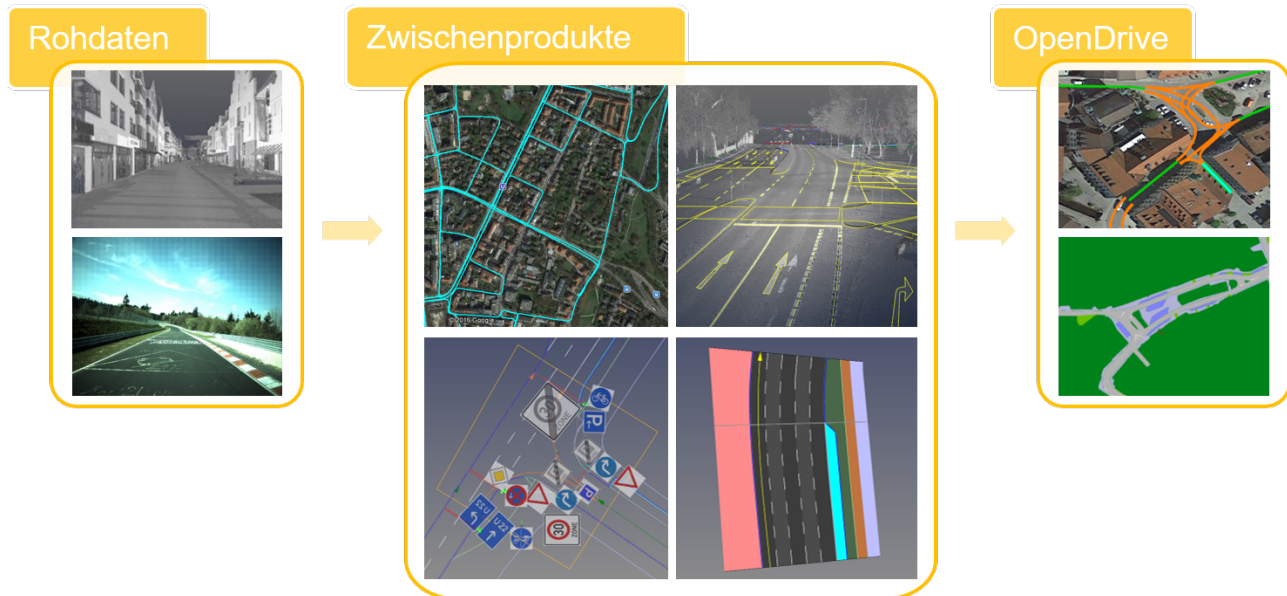
Abbildung 1.1 – Überblick über den Datenauswertungs- und Modellierungsprozess bei 3D Mapping Solutions (Bildquellen: 3D Mapping Solutions)
