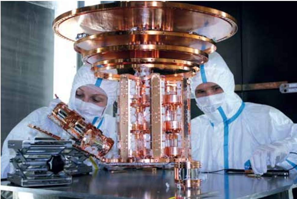
Bild 1: Forscher des CRESST Projektes beim Einbau von Detektoren, welche im Inneren Calciumwolframatkristalle enthalten.
