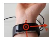
Abb. 2: Sensor-Orientierung des MSB2
