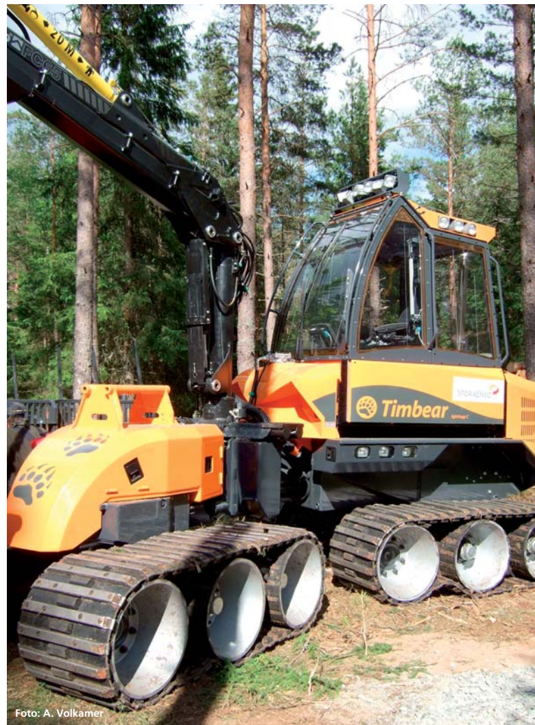
Abbildung 3: Das Kombigerät Timbear Lightlogg C – hier in der »Harvester-Konfiguration« – ist besonders für schwächeres Holz geeignet.
