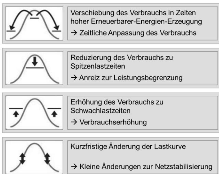
Abbildung 3-1: Lastverschiebearten im Rahmen des Lastmanagements
