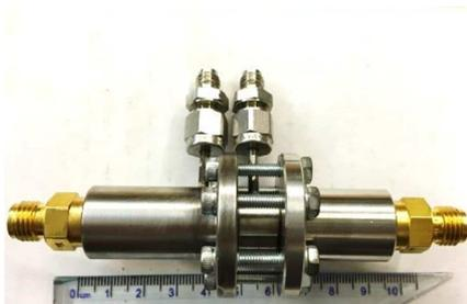
Fig. I.5. Venturi flow meter
