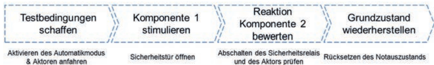
Bild 1: Phasenmodell eines Testfalls einschließlich beispielhafter Testschritte
