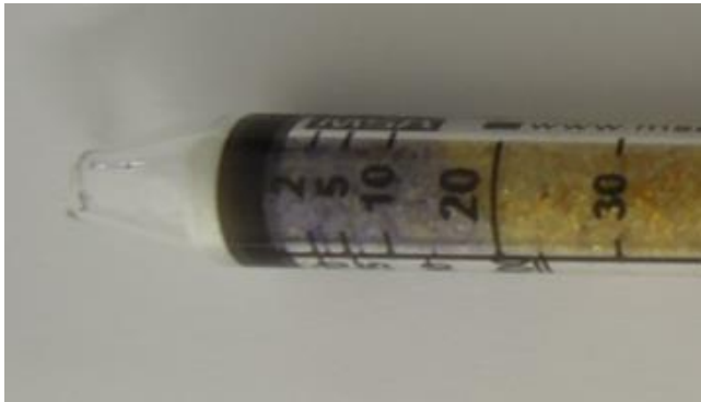
Abb. 2: Dräger Teströhrchen mit einem Messergebnis von etwa 15 bis 18 ppm \text{NH}_3
