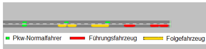
Abbildung 4.8: Simulationsausschnitt von einem Platoonführer, der das Netzelement verlässt
