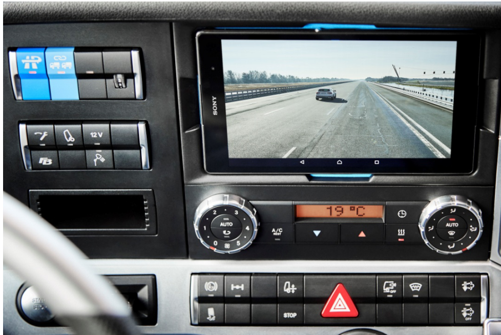
Abbildung 2.6: Bildübertragung des Verkehrsgeschehens vor dem Führungsfahrzeug [Daimler AG]
