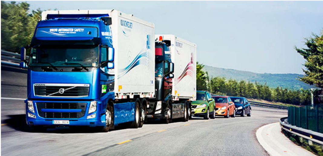
Abbildung 2.4: Inhomogenes Mischplatoon des Projekts SARTRE [Institut für Kraftfahrzeuge, RWTH Aachen, 2012]
